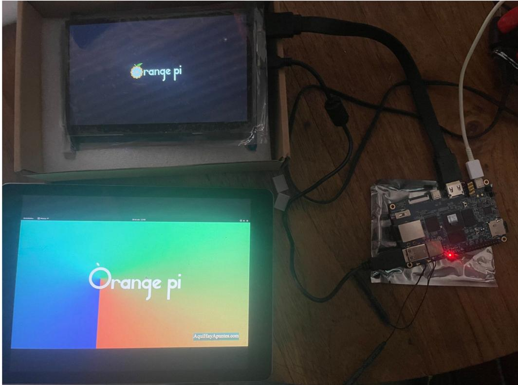
Figura 2.6: Conexión física de los componentes del hardware
