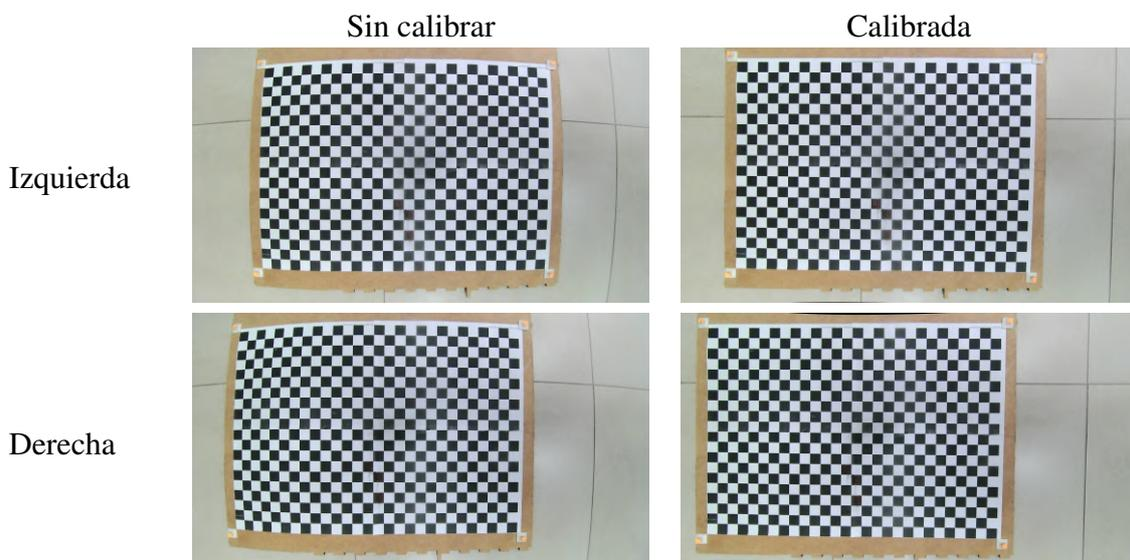
En (figura 10) se muestra un ejemplo del resultado de calibración, se puede apreciar como las líneas horizontales y verticales del patrón aparecen curvas en las imágenes sin
