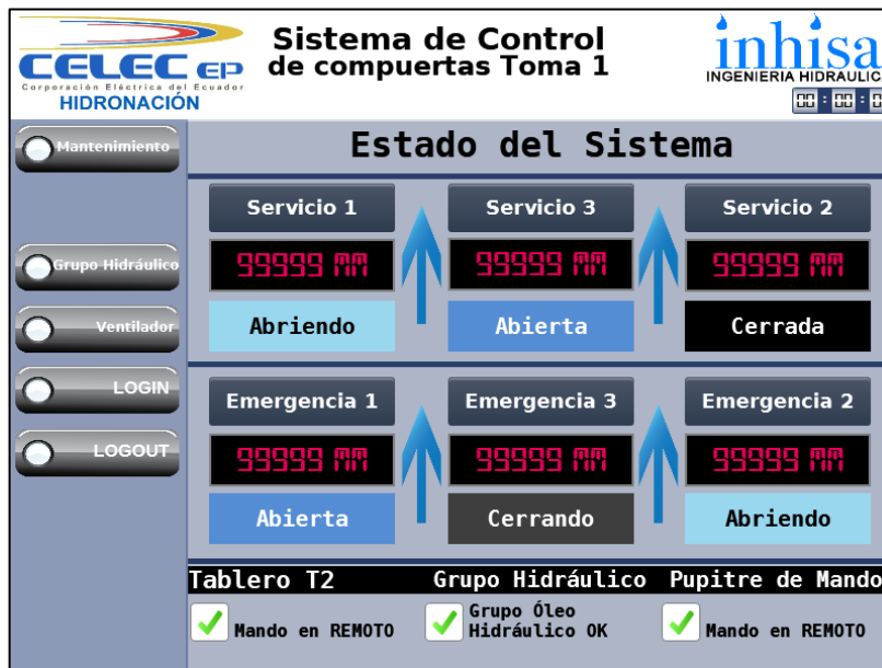
Figura 21.- Pantalla de estado de compuertas [3].
