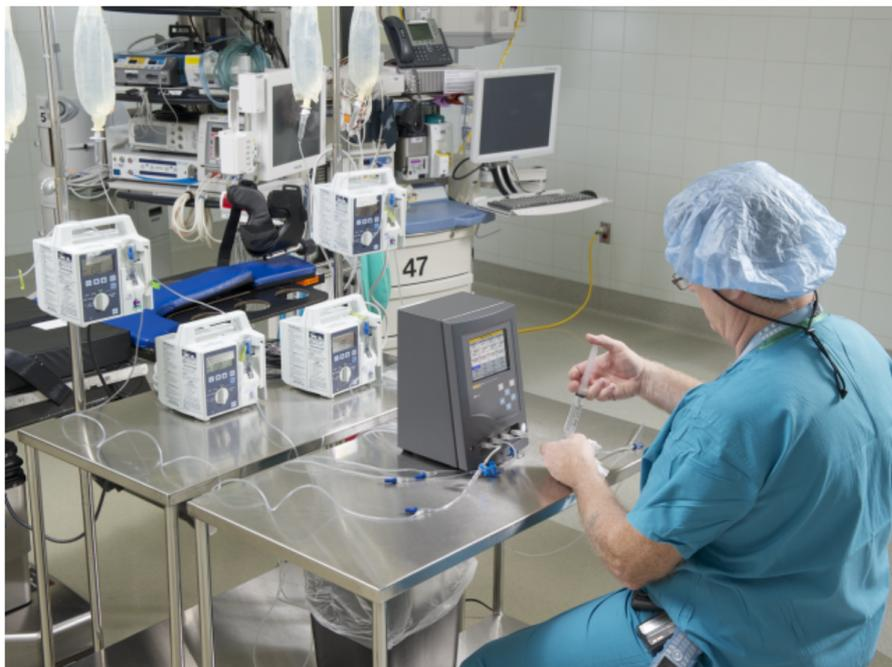
**Figura 3.22 Conexión y funcionamiento IDA 5 [44]**
