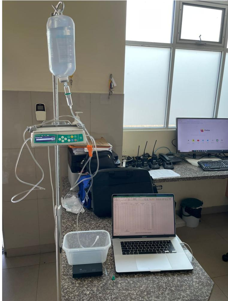
**Figura 4.3 Implementación del piloto de verificación metrológica para bombas de infusión volumétricas**
