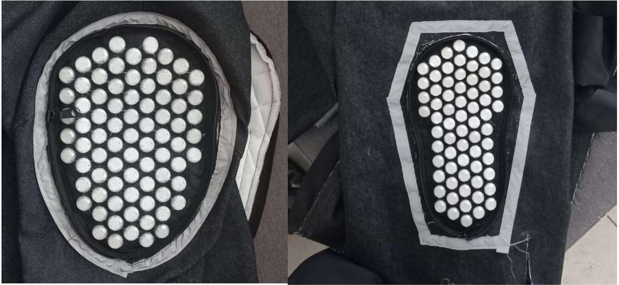
Figura 34 Prueba de distribución de cinta reflectiva alrededor de los protectores.
