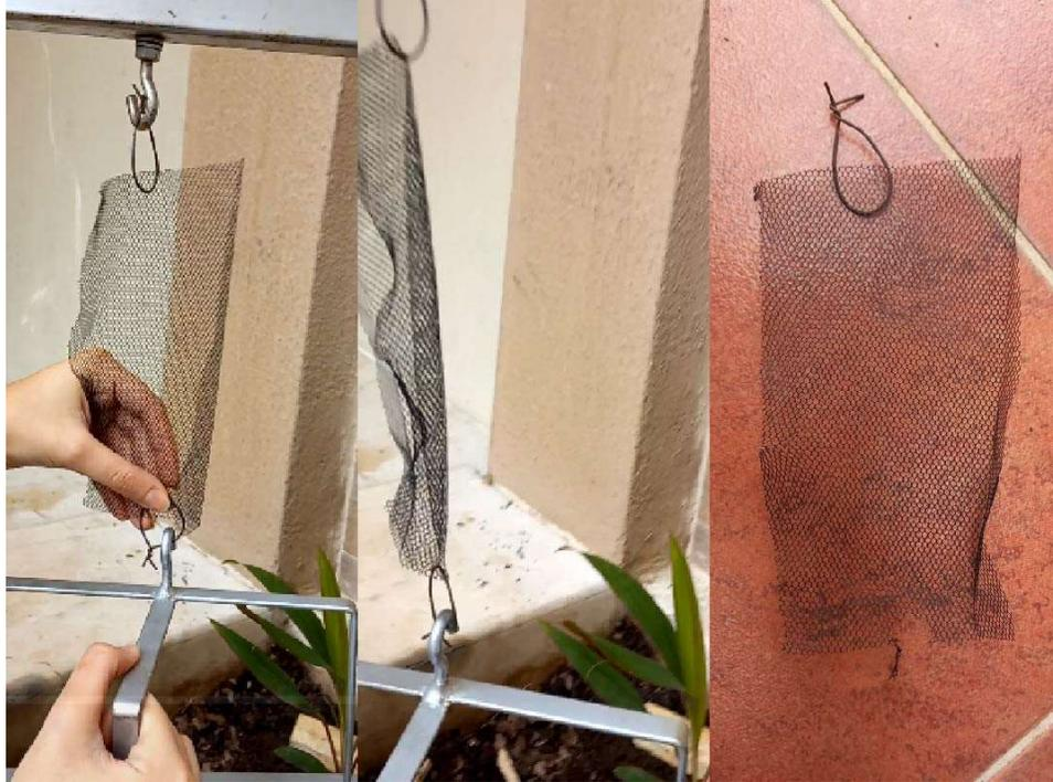
Figura 25 Resultados simulación de ensayo de tracción en malla de crinolina.
