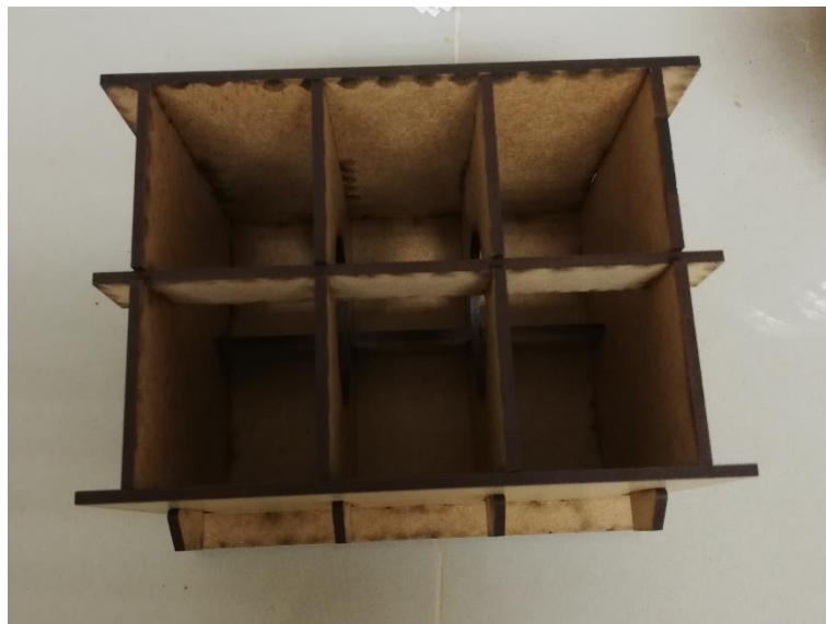
Figura 3.20: Molde para experimentación de crecimiento del micelio en MDF.
