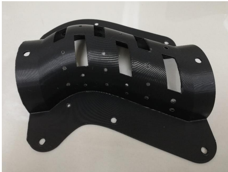
Figura 4.14: Modificación de agujeros a la pieza superior del molde físico.
