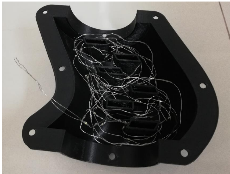
Figura 4.26: Fotografía de la pieza inferior del molde con las luces hada acomodadas.
