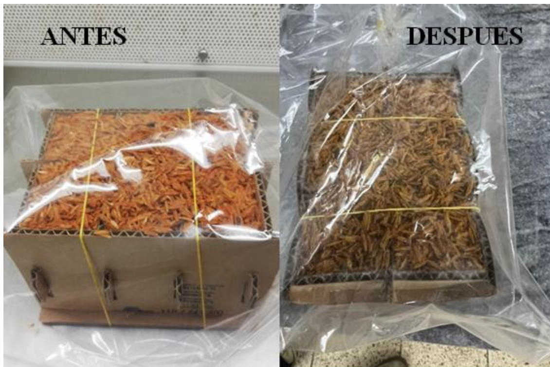
Figura 3.18: Experimentación del crecimiento de micelio en cartón.
