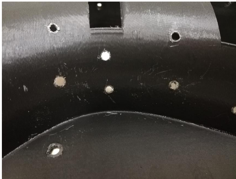
Figura 4.15: Vista a detalle de la modificación de agujeros a la pieza superior del molde físico.
