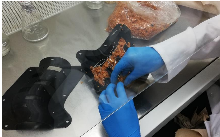
Figura 4.27: Fotografía compactando el composite de micelio con sustrato de aserrín en el molde.
