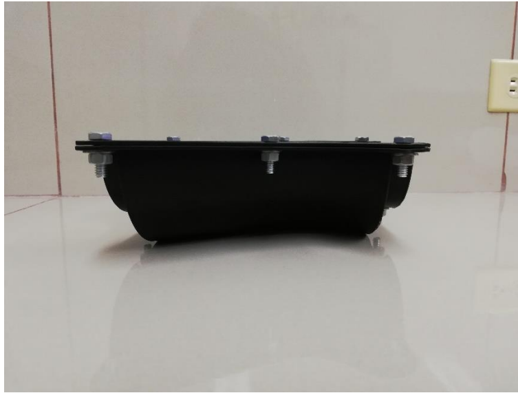
Figura 7.5: Fotografía en vista lateral del molde físico con pernos.
