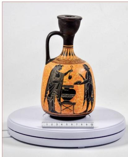
**Figura 4.** Ejemplo de fotogrametría. Pieza sobre una plataforma giratoria motorizada para realizar fotografías a intervalos angulares de  $10^\circ$  a  $15^\circ$ . Tomado de Felísimo et al., (2020)
