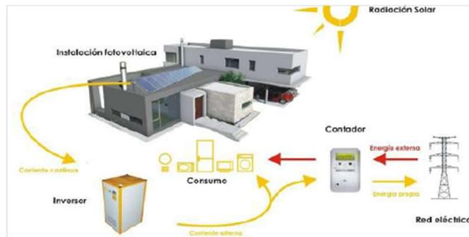
Figura 2.1.1. Esquema del sistema fotovoltaico (Energycontrol, 2023)
