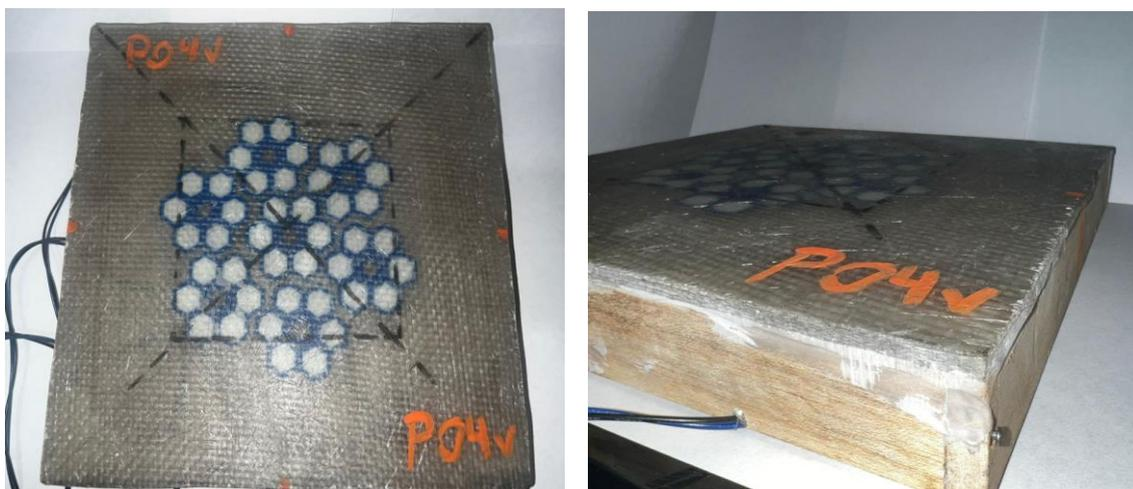
*Nota:* Se observa que el panel está en óptimas condiciones, pero se recomienda mejorar la condición de frontera de empotramiento.
