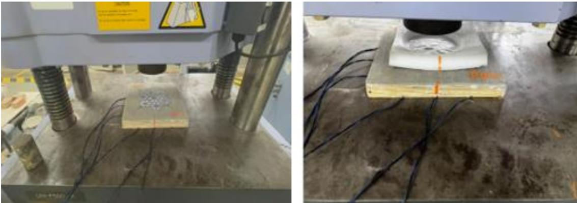
Entonces, para la ejecución de las pruebas de flexión, se utilizó el equipo UH-11FX, el national instruments y con la computadora anexada a la máquina se programaron 8 cargas cíclicas en un intervalo de 20 N a 7 000 N reproduciendo la acción del slamming en la probeta. De esta manera, se registró el tiempo, el desplazamiento del pistón y fuerza por cada impacto en su respectiva probeta en un tiempo aproximado de 90 minutos por probeta.
