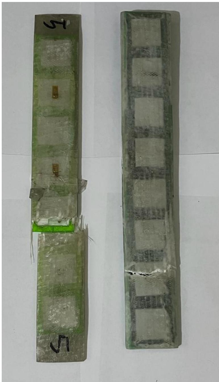
*Nota:* Se observa que existe una ruptura y delaminación debido a los auxéticos colocados en el primer espécimen, pero en el segundo espécimen no se presenta una delaminación tan pronunciada.
