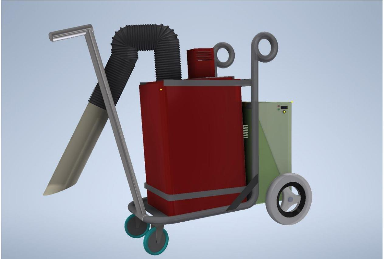
Como se observa en la *Figura 3.11*, el manubrio que se encuentra junto a la estructura, tiene como función principal, movilizar el dispositivo, adaptándose a operadores diestros y zurdos.
