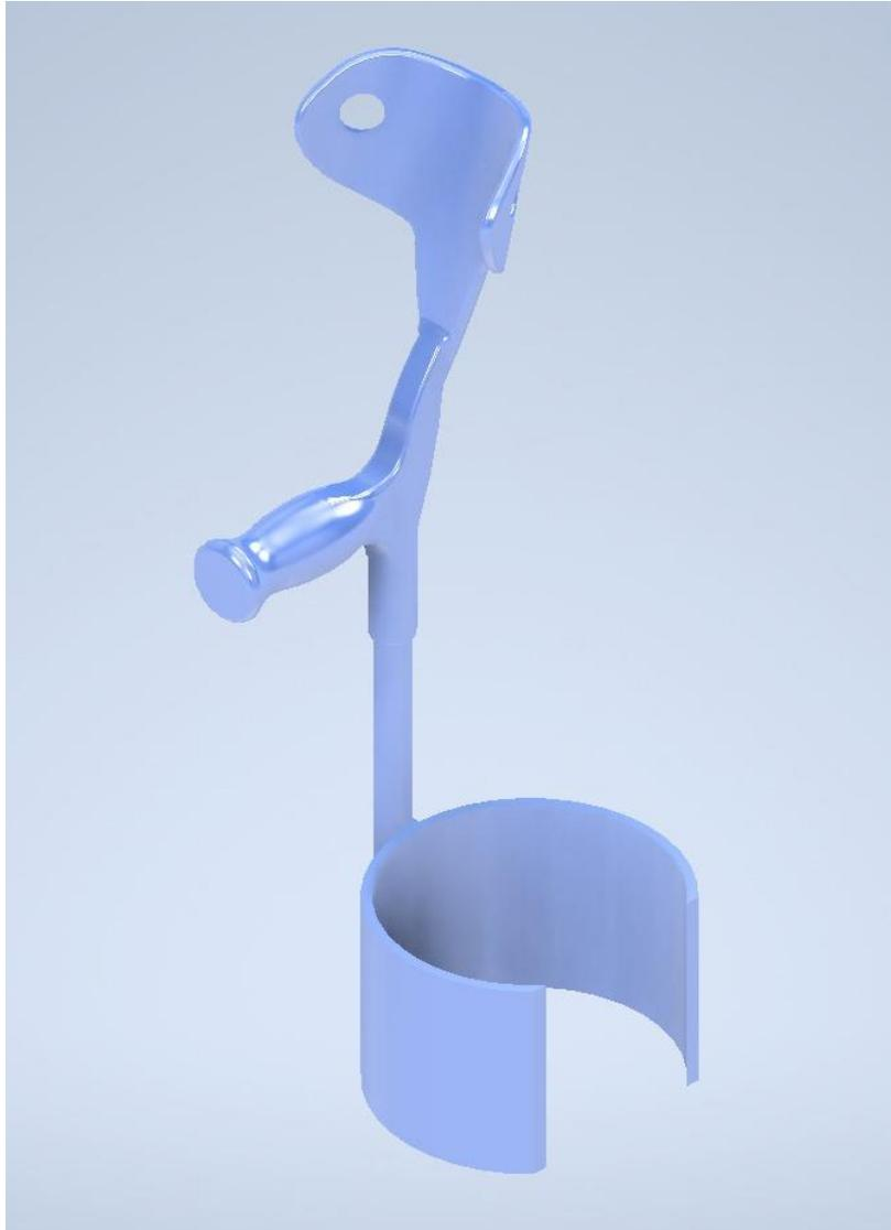
Este dispositivo mostrado en la *Figura 3.12* fue diseñado para permitir la maniobrabilidad y movimiento del tubo flexible, objetivo de proporcionar mayor comodidad al operador durante el uso de la aspiradora.
