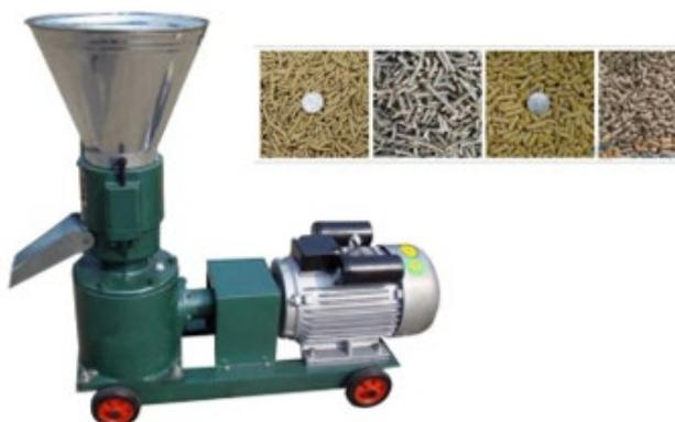
En relación con la planta de alimento peletizado de la empresa abordada en este proyecto, se presenta un ejemplo específico de las máquinas peletizadoras empleadas, como se ilustra en la Figura 1.12. En esta, se destacan elementos clave, tales como un acondicionador, motor principal y prensa.
