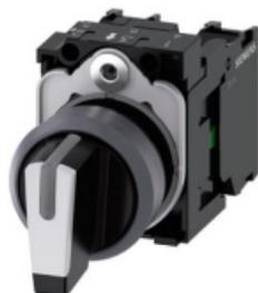
selector, iluminable, 22 mm, redondo, plástico con anillo frontal de metal, blanco, selector, corto, 3 posiciones I-O-II, sostenido, ángulo de conmutación 2x45°, 10:30h/12h/13:30 h, con soporte, 1 NA, 1 NA, borne de tornillo
