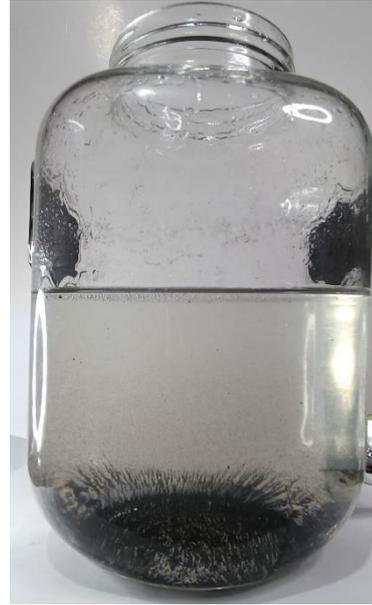
Al simular una descarga por una llave inferior (reubicando las bobinas únicamente durante este experimento), se puede observar cómo las partículas se adhieren a las superficies donde se encuentran las bobinas. Se comprueba que las partículas se mantienen retenidas, mientras el nivel del líquido desciende hasta vaciar el recipiente.
