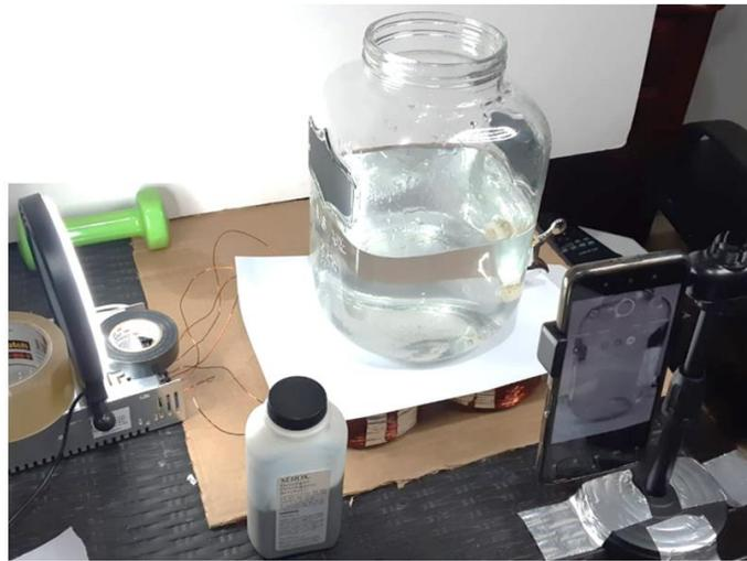
En la segunda prueba se simuló la descarga por gravedad del líquido. Para esto, se elevó y giró el recipiente, para que la llave de salida se ubique en la parte inferior. Adicionalmente, se reubicaron los electroimanes solo por esta prueba para poder visualizar la retención de las partículas en las paredes, mientras el líquido se evacúa.
