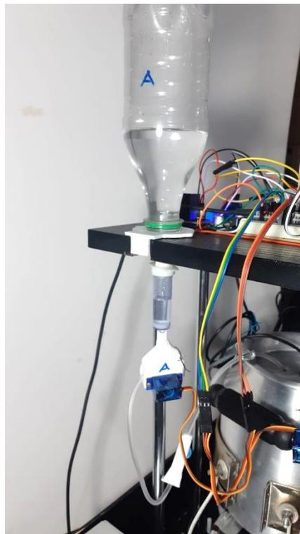
Para el control, el sensor mide el pH actual y, en caso de no encontrarse en el rango indicado, administra la solución necesaria (ácida o básica) durante 5 segundos. Luego, se esperan 15 segundos mientras la solución se mezcla correctamente con el contenido antes de la siguiente medición. Siguiendo esta lógica se obtuvieron los siguientes resultados para un escenario ácido entre pH4.5 y pH5.5, y un escenario básico entre pH7 y pH8.
