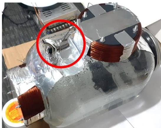
Finalmente, se evaluó la posibilidad de extraer el líquido mediante una bomba de 12V. Para esto, se regresó el equipo a su posición definitiva, y se colocó una manguera a una altura de 1.5cm del fondo del recipiente. De esta forma, se comparó la cantidad de partículas de hierro succionadas por la bomba cuando los electroimanes se encuentran encendidos y apagados.
