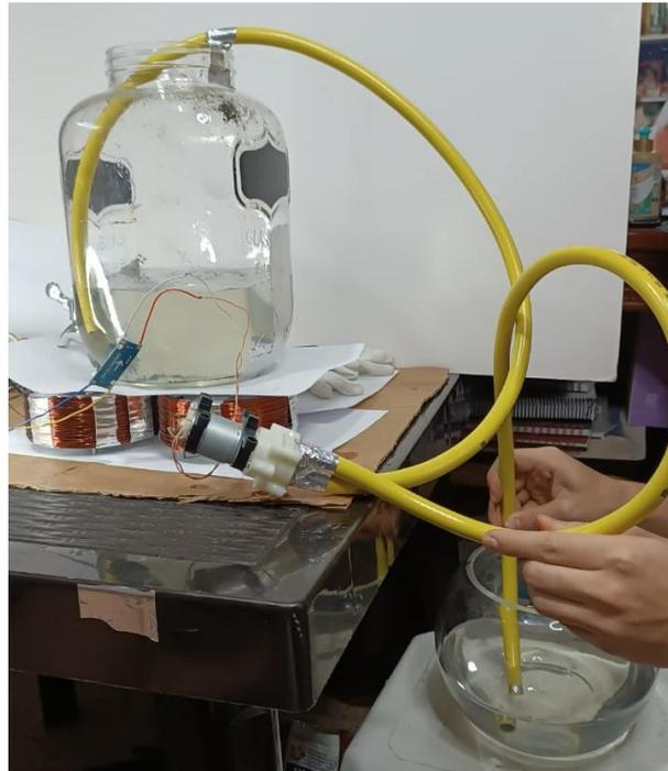
A esta alternativa se adicionó un sensor de nivel ultrasónico HC-SR04, el cual permite apagar la bomba cuando el producto haya sido descargado.
