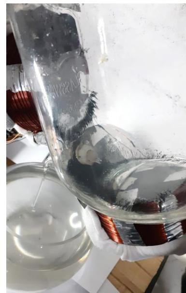
Finalmente, se realizaron pruebas utilizando una bomba de succión. Se observó que al extraer el líquido sin activar los electroimanes, parte de las partículas de hierro son removidas del recipiente. Por otro lado, al repetir el experimento bajo la acción del campo magnético, todas las partículas se mantuvieron dentro del recipiente, comprobando nuevamente la eficacia del sistema de retención mediante campos magnéticos.
