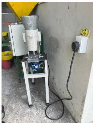
4. La máquina se inicia sin biomasa, con solo la matriz y rodillos en movimiento; luego, se procede a ajustar los rodillos en ambos lados hasta lograr un giro uniforme.
