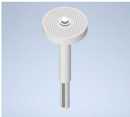
*Nota.* Trasmisión de potencia directa desde el reductor del motor hacia el eje principal de la pelletizadora. Utiliza eje sólido con chavetero para transmitir la potencia.
