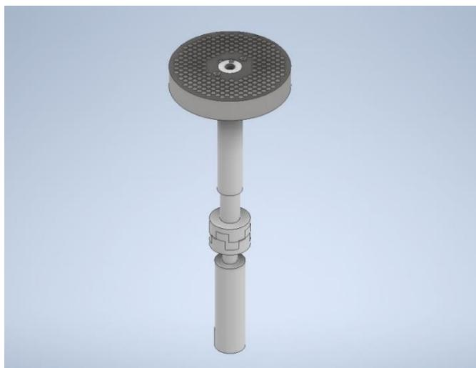
*Nota.* Su elemento de transmisión es un acople flexible o matrimonio que permite la unión rápida entre el reductor del motor y el eje principal de la pelletizadora.
