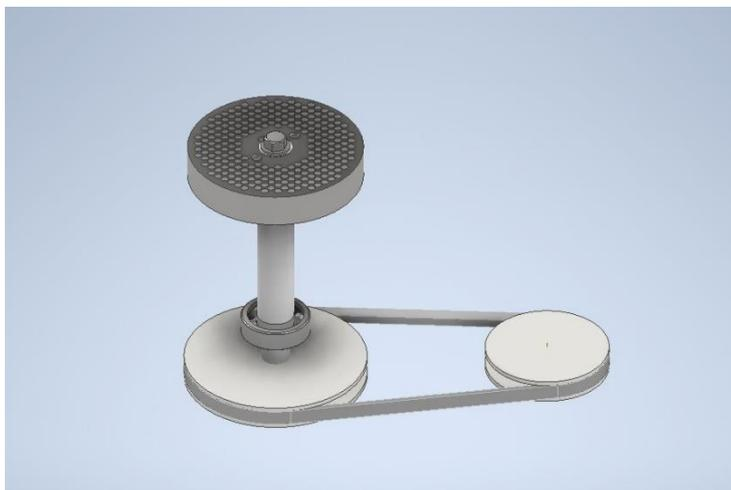
*Nota.* La figura muestra la transmisión por polea y banda. Este sistema permite reducir velocidades de giro a conveniencia.
