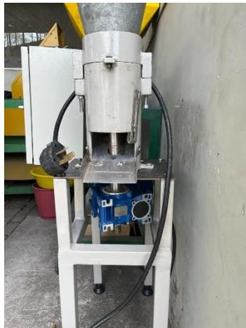
9. Se desarmar la parte del cilindro superior con el fin de limpiar los residuos que quedan del pelletizado.
