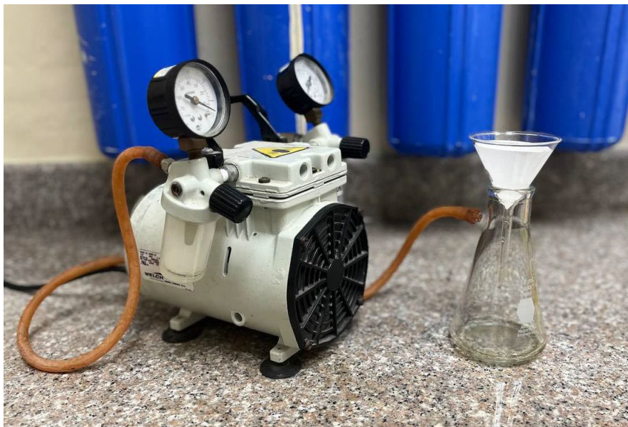
Ilustración 3. Sistema armado para filtración al vacío del extracto de pectina de la Cascarilla de cacao
