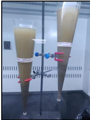
**Ilustración 8.** Conos Imhoff utilizados para determinar sólidos sedimentables.
