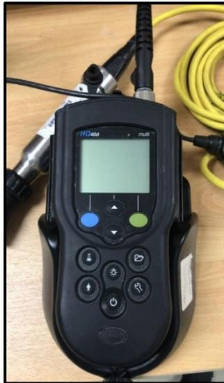
**Ilustración 6.** Equipo empleado para el determinar el pH.
