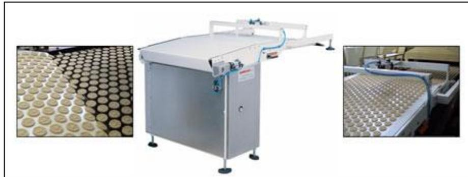
FIGURA 2.47. BANDA SEPARARADORA DE RECORTE
