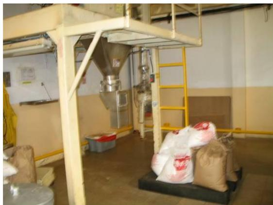
**FIGURA 2.34. FOTO DE UN MOLINO DE SAL**
