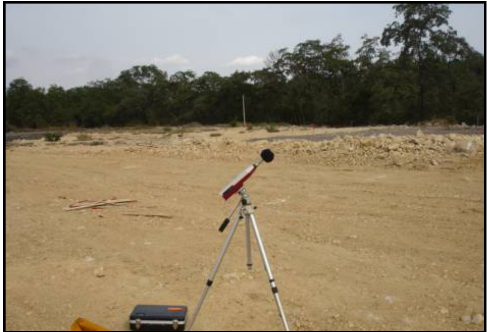
Figura 3.4 Equipo Sonómetro empleado para la medición de los niveles de ruido en el área del proyecto.
