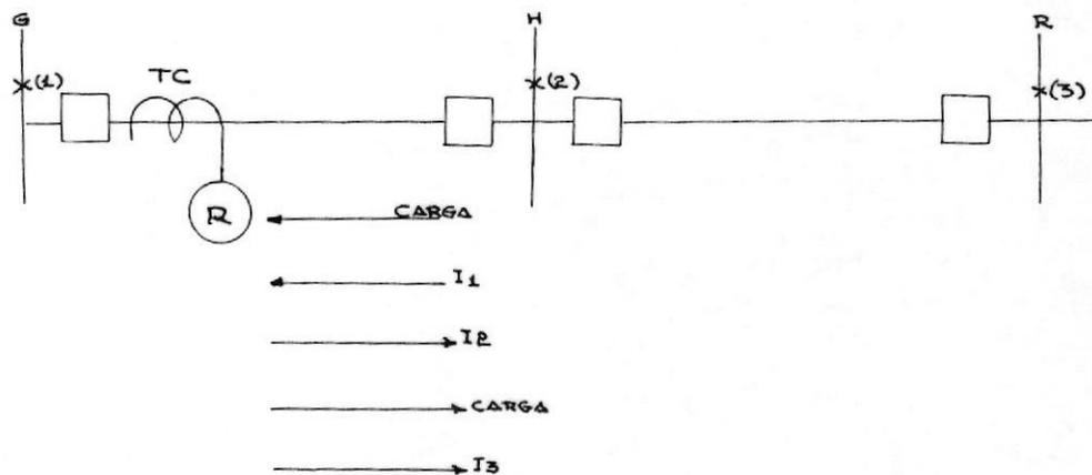
FIGURA N<sup>o</sup> 3.15.- CRITERIO PARA REQUERIR UNA UNIDAD DIRECCIONAL EN RELE DE DISYUNTOR "A".
