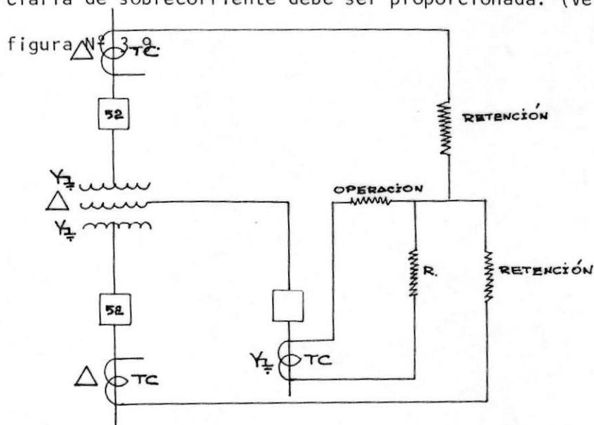
FIGURA N° 3.9.-PROTECCION TERCIARIA DEL TRANSFORMADOR DE TRES DEVANADOS.-
