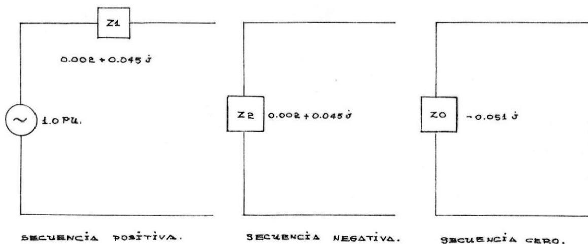
FIGURA N<sup>o</sup> 2.13.- CIRCUITO ELECTRICO EQUIVALENTE DEL S.N.I.
