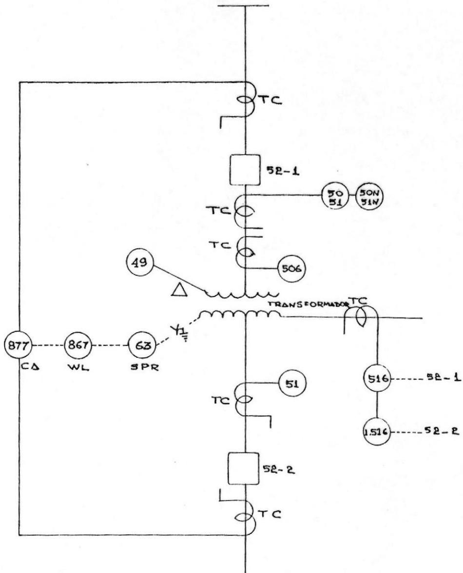
FIGURA N° 3.11.- PROTECCION DEL TRANSFORMADOR CON DISYUNTOR
