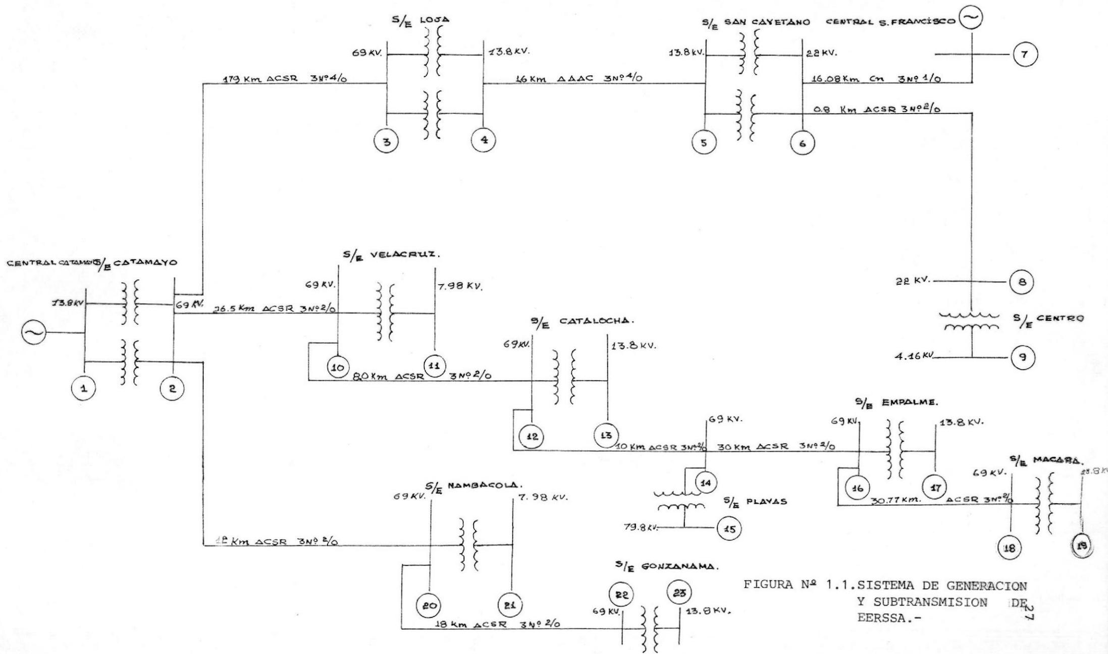
FIGURA Nº 1.1. SISTEMA DE GENERACION Y SUBTRANSMISION DE EERSSA. - 27
