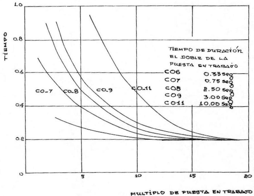
FIGURA N° 3.13.- CARACTERISTICAS TIEMPO - CORRIENTE
