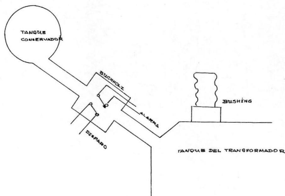
FIGURA N° 3.7.- PRINCIPIO DEL RELE BUCHHOLZ
