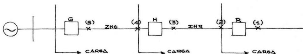
FIGURA N° 3.14.- ALIMENTADORA RADIAL TÍPICA
