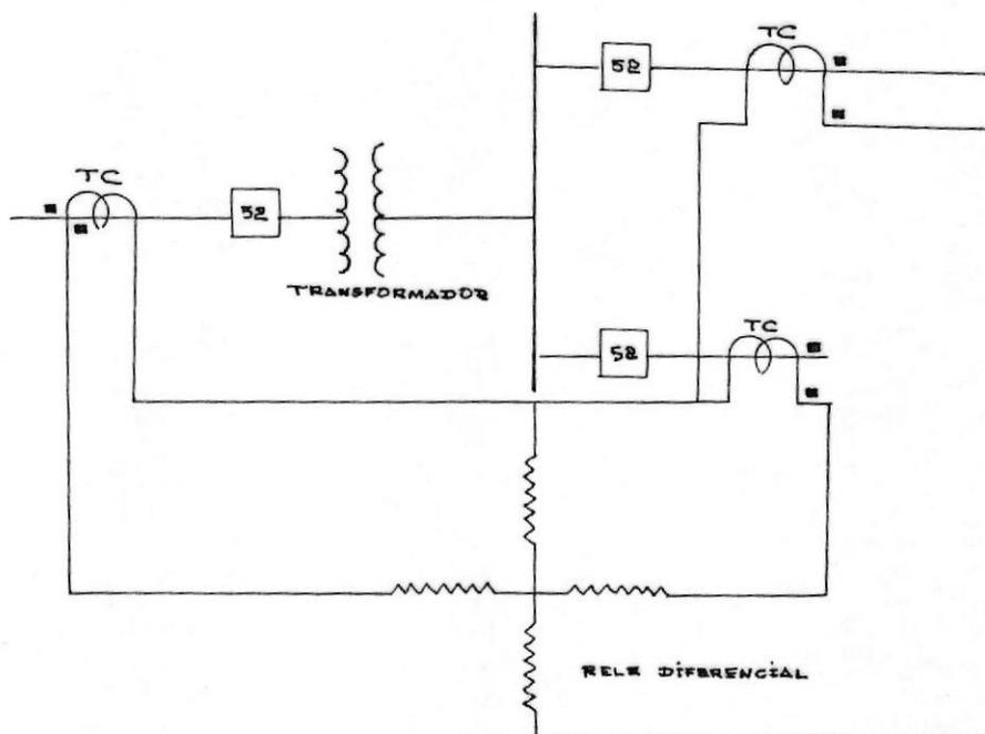
FIGURA N° 3.6.- PROTECCION COMBINADA DE TRANSFORMADOR Y BARRA COLECTORA CON UN RELEVADOR DE PORCENTAJE DE TRES ARROLLAMIENTOS.
