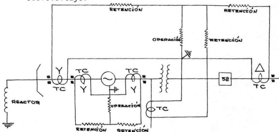
FIGURA N° 3.10.-PROTECCION DIFERENCIAL DEL TRANSF.GENERADORES
