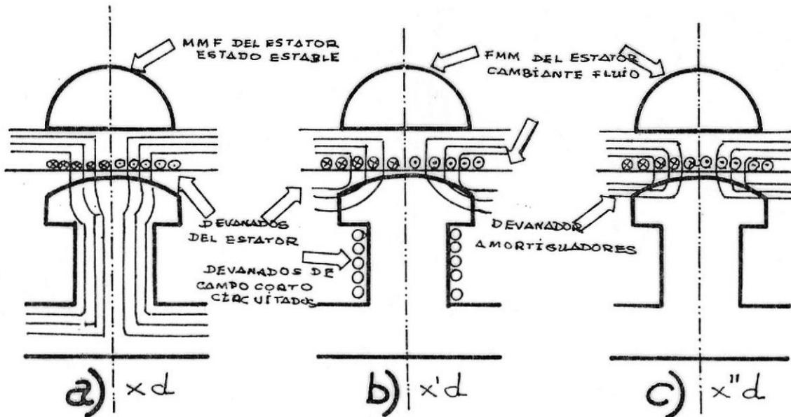
FIGURA N° 2.2. TRAYECTORIAS DE FLUJO SINCRONICO,BAJO CONDICIONES TRANSIENTES.-
