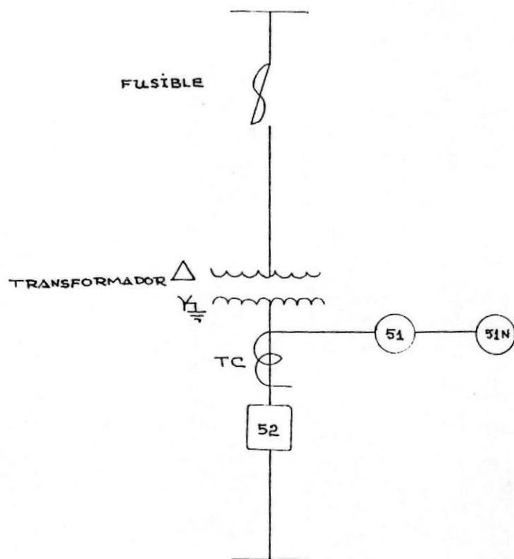
FIGURA N° 3.12.- PROTECCION DEL TRANSFORMADOR SIN DISYUNTOR
