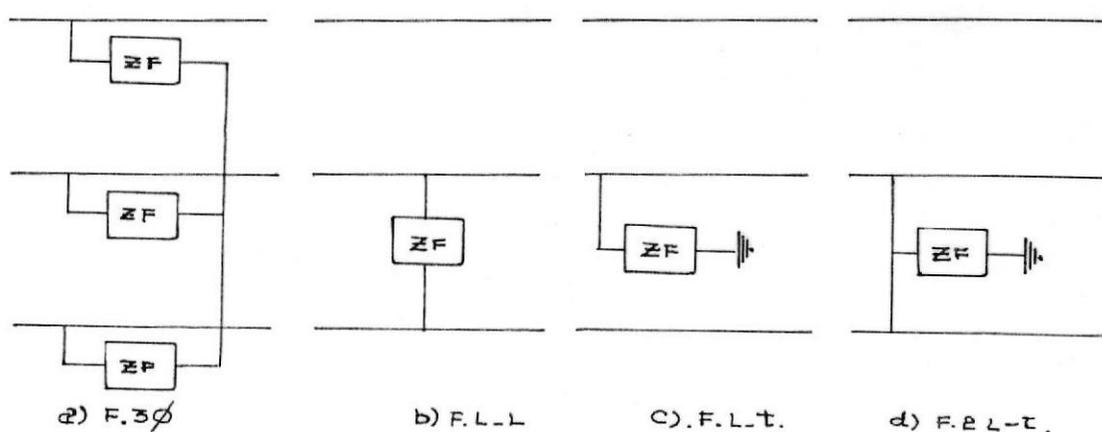
FIGURA N<sup>o</sup> 2.12.- FALLAS POSIBLES EN UN SISTEMA DE POTENCIA
