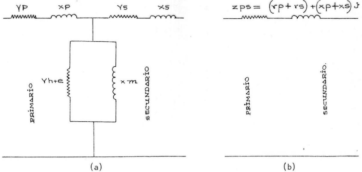
FIGURA N° 2.3. CIRCUITO EQUIVALENTE DEL TRANSFORMADOR
