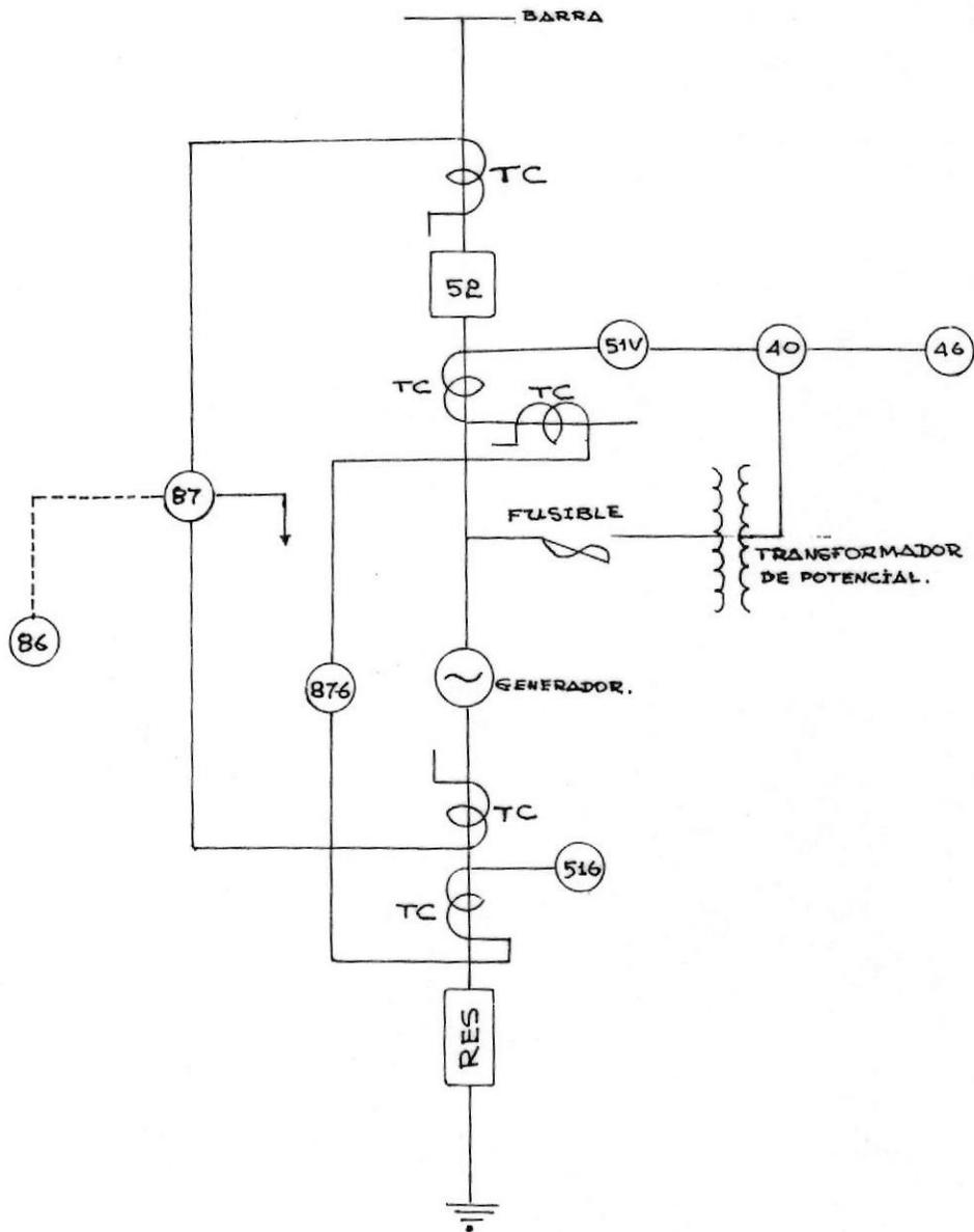
FIGURA N° 3.3.- PROTECCION MINIMA PARA GRANDES GENERADORES
