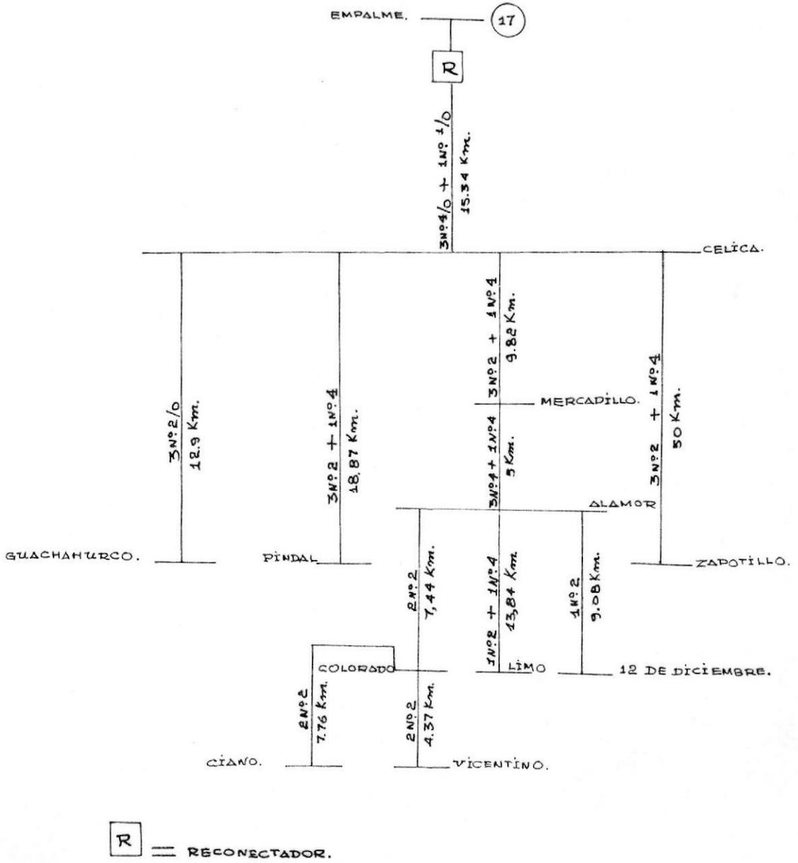
FIGURA N° 1.3. SISTEMA DE DISTRIBUCION DE EL EMPALME
