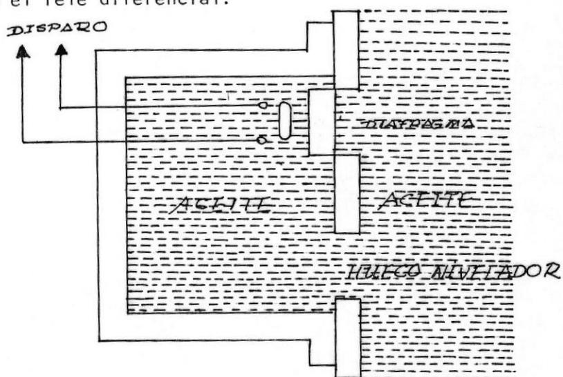
FIGURA N° 3.3.- PRINCIPIO DEL RELE DE PRESION SUBITA
