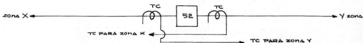
FIGURA N° 5.1. PRINCIPIO DE SUPERPOSICION DE ZONAS DE PROTECCION
