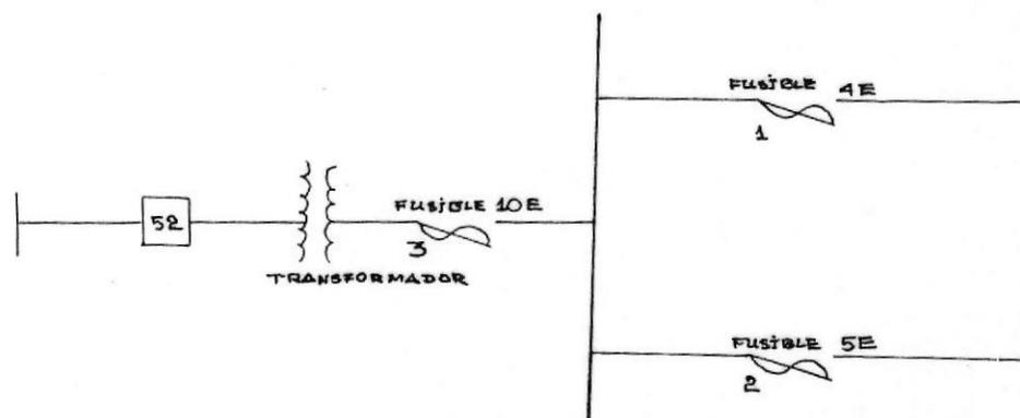
FIGURA N° 3.16.- ESQUEMA DE PROTECCION CON FUSIBLES
