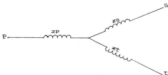
FIGURA N° 2.6.- CIRCUITO EQUIVALENTE DEL TRANSFORMADOR DE TRES DEVANADOS.
