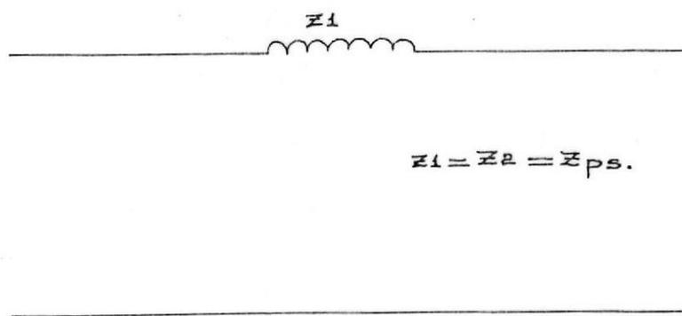
FIGURA N° 2.4.- IMPEDANCIAS DE SECUENCIA POSITIVA Y NEGATIVA DE TRANSFORMADORES.
