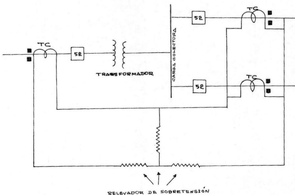
FIGURA N° 3.5.-PROTECCION COMBINADA DE TRANSFORMADOR Y BARRA COLECTORA CON UN RELE DIFERENCIAL DE PORCENTAJE DE DOS ARROLLAMIENTOS.
