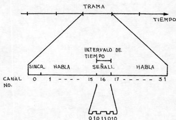
fig. 3.8 Configuración del tramado PCM (MIC)
