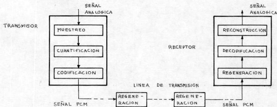
fig. 4.1 Sistema básico de transmisión PCM
