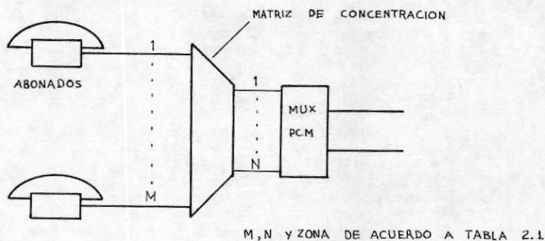
fig 2.1 Configuración de concentrador
