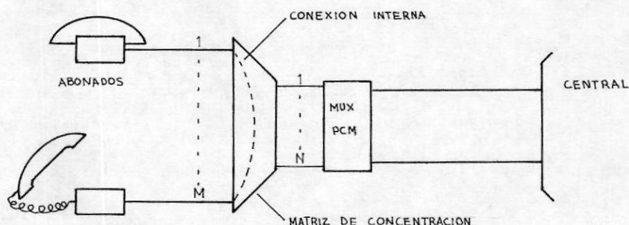
fig. 2.2 Conexión de 2 abonados
