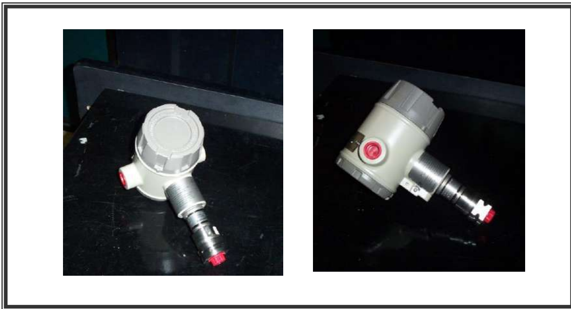
Figura No. 7.14 Medidor de Presión de Vapor Recalentado
