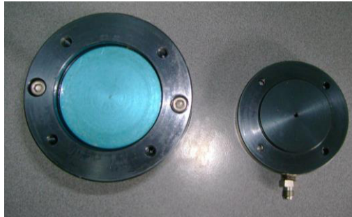
FOTO 6. VISTA SUPERIOR DE LA BASE DEL POROSIMETRO CON LA CAMARA DE SELLO DEL PORTA MUESTRA SEPARADA
