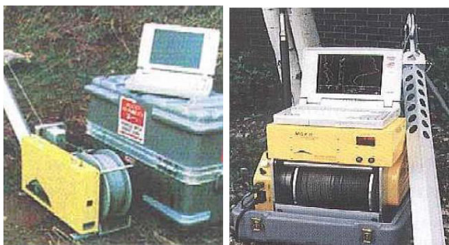
FIGURA 2.1.2 EQUIPOS DE REGISTRO DE POZOS PETROLIFEROS
