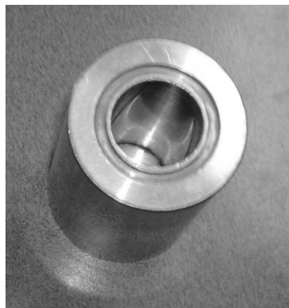
FIGURA 3.3.3 CÁMARA PORTA NÚCLEO #1
