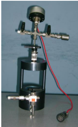
FOTO 1. VISTA FRONTAL DEL POROSIMETRO DE HELIO
