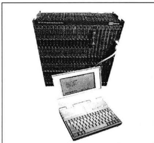
FIGURA 3.20 Unidad de Supervisión Portátil "Craft Interface Unit"
