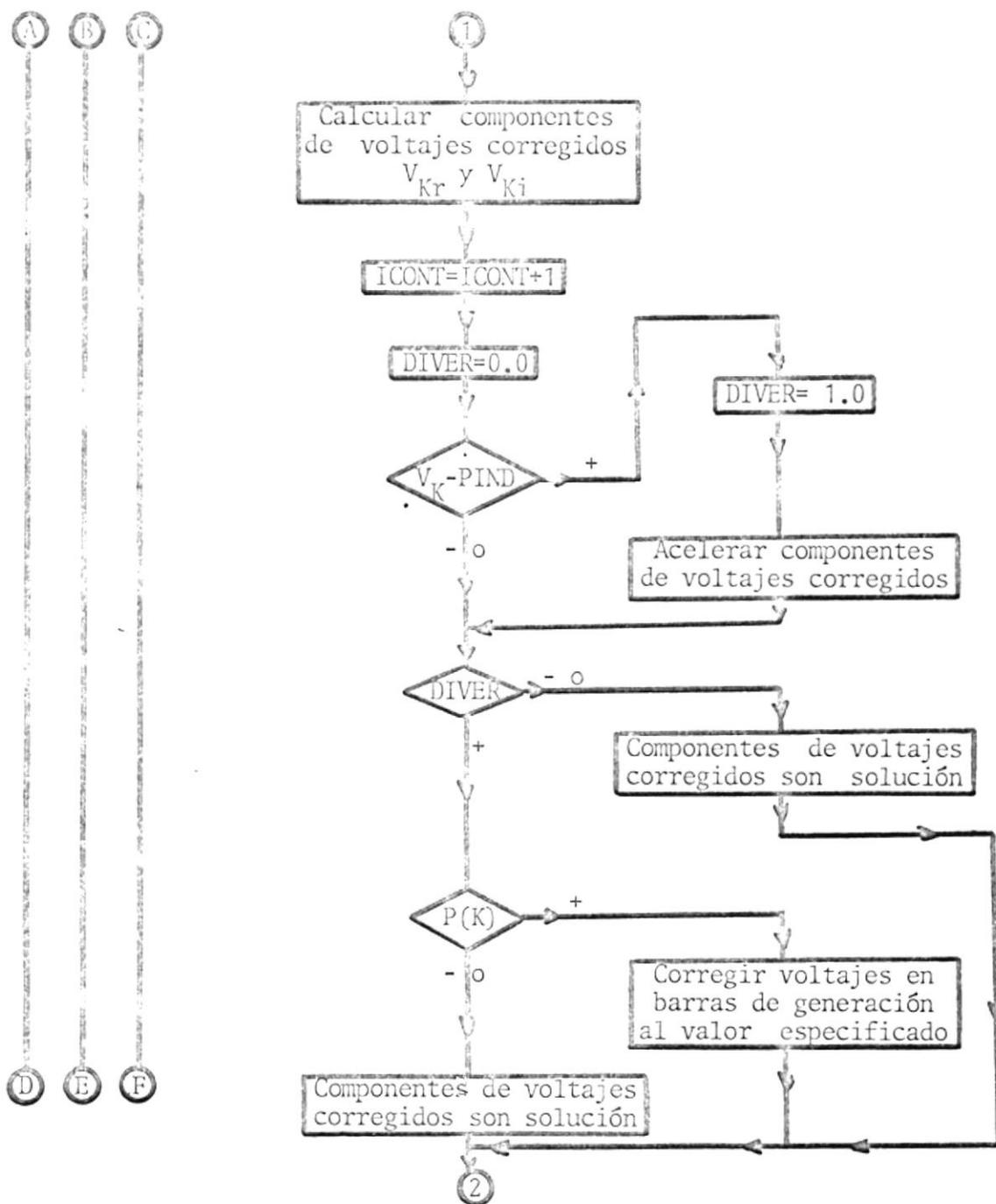
Figura IV-8. Diagrama de flujo para proceso iterativo (continuación).
