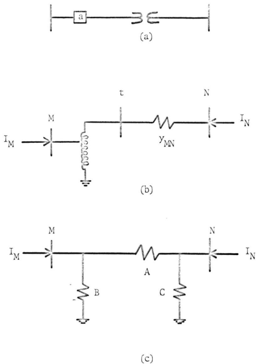
Figura II-5. Representación de transformadores con razón de transformación fuera de lo nominal
