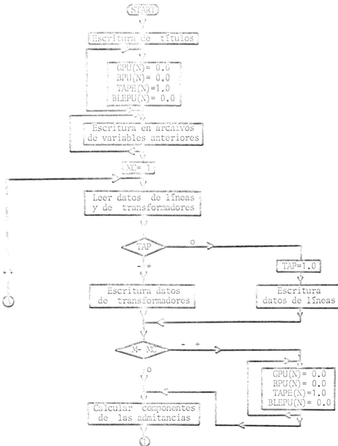
Figura IV-3. Diagrama de flujo para datos de líneas y transformadores.
