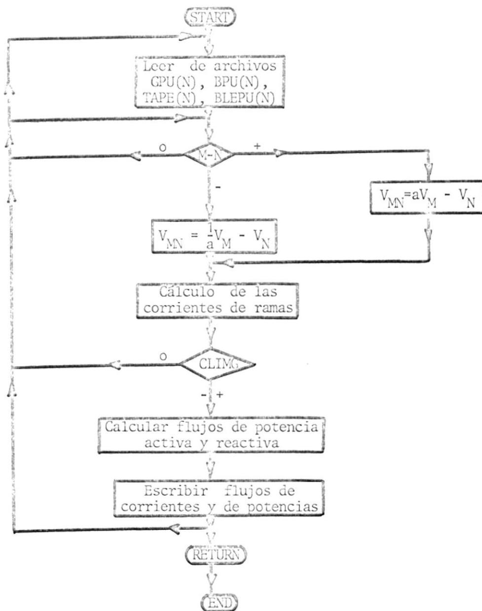
Figura IV-12. Diagrama de flujo para calcular flujos de potencia.
