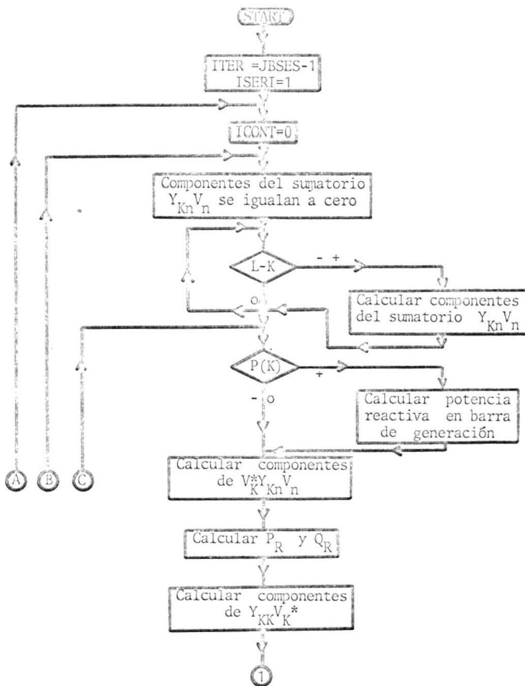
Figura IV-7. Diagrama de flujo para proceso iterativo.
