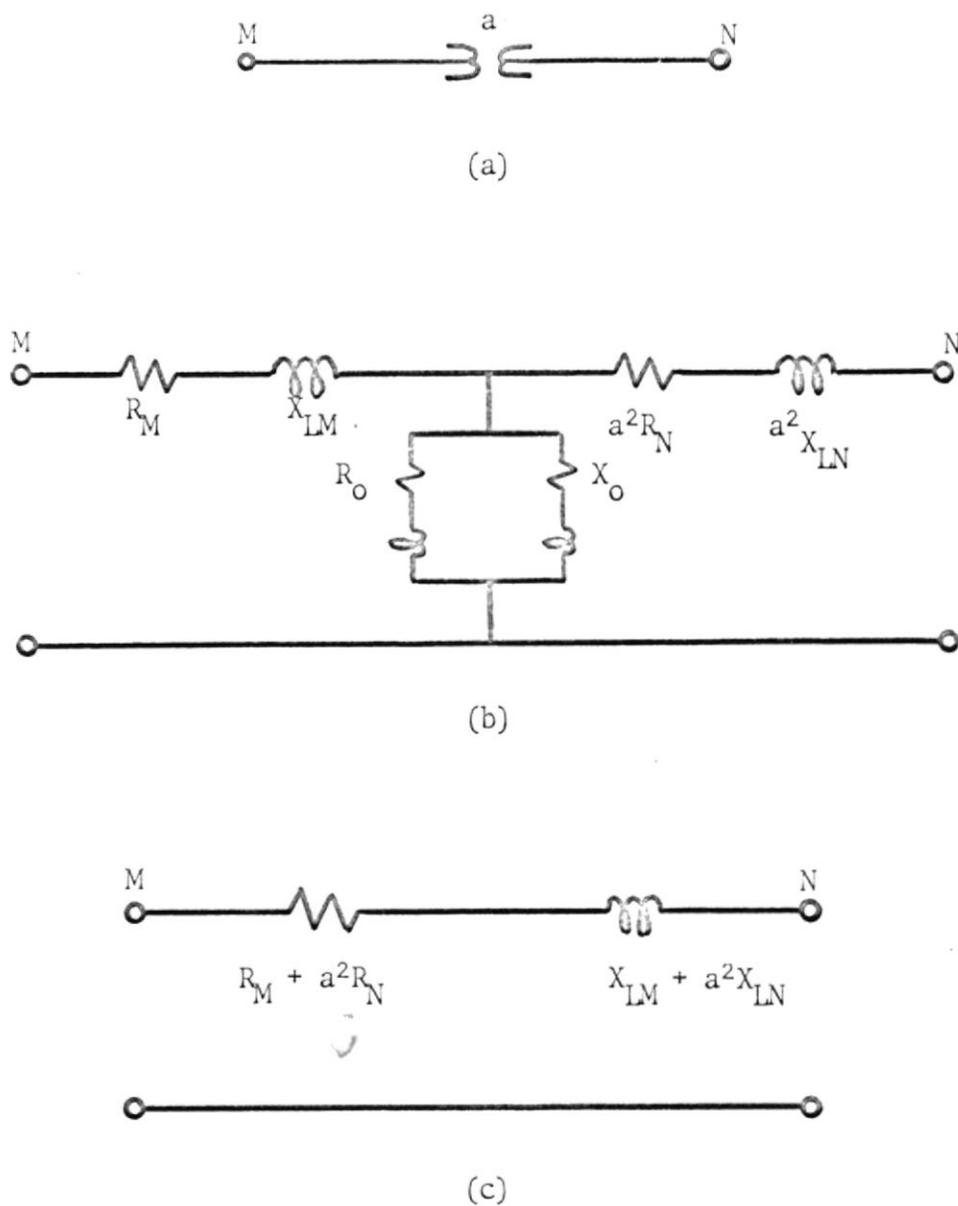
Figura II-4. Circuito equivalente de transformadores
