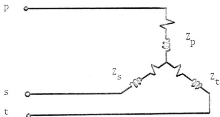
Figura II-6. Circuito equivalentes de transformadores de dos y tres devanados
