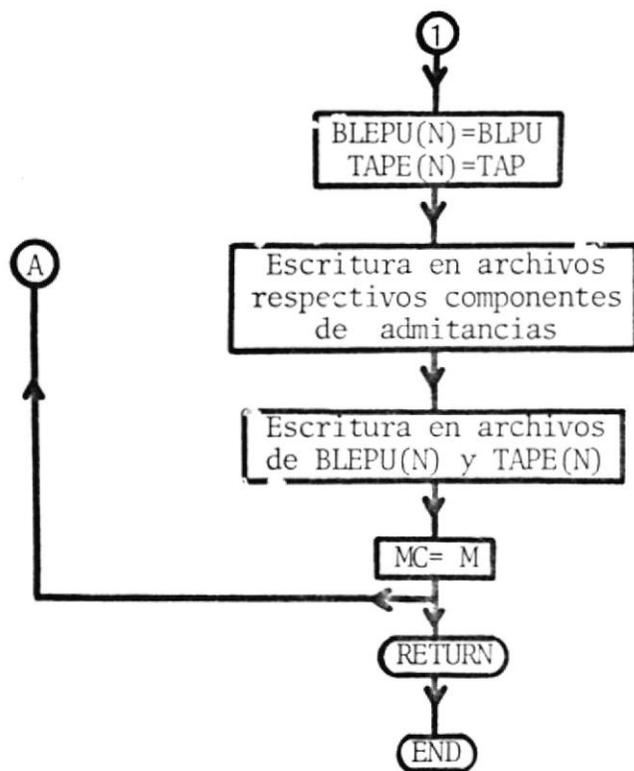
Figura IV-4. Diagrama de flujo para datos de líneas y transformadores (continuación).
