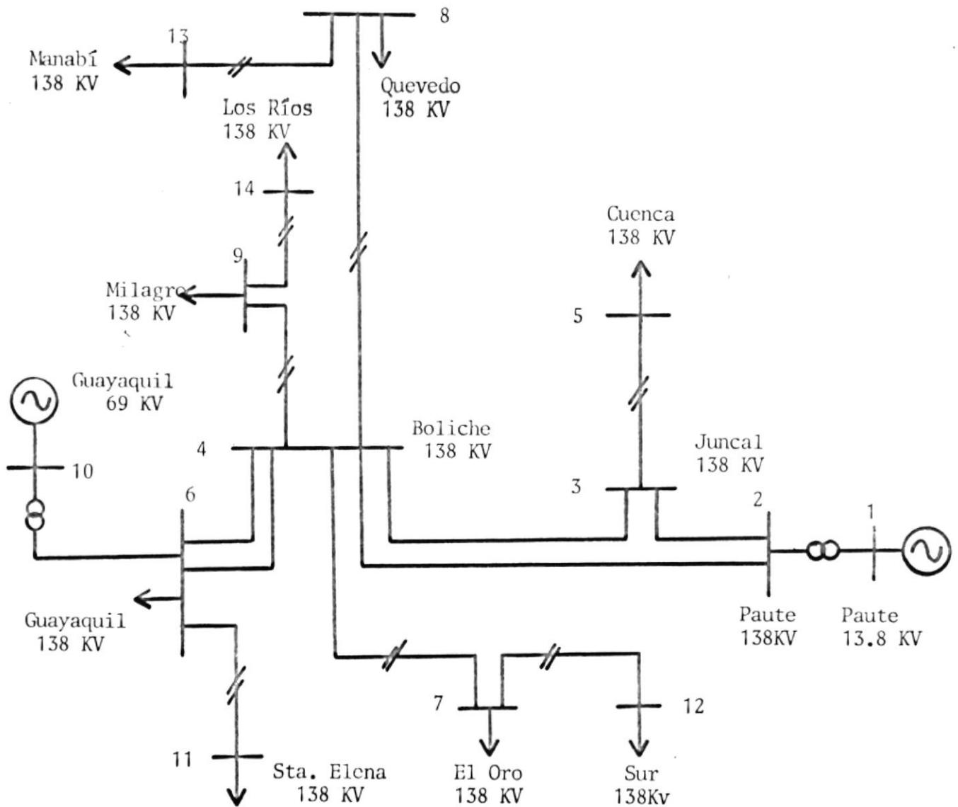
Figura V-1. Diagrama unifilar del sistema Paute - caso base.
