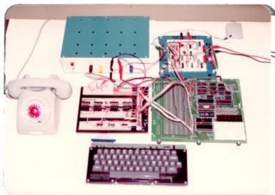
FIGURA N° 3.2. SISTEMA APOYADO EN EL SDK - 85
