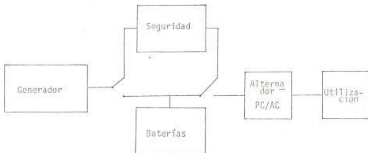
FIGURA 13. DIAGRAMA DE BLOQUES DE UN SISTEMA CON GENERADOR FOTOVOLTAICO.-
