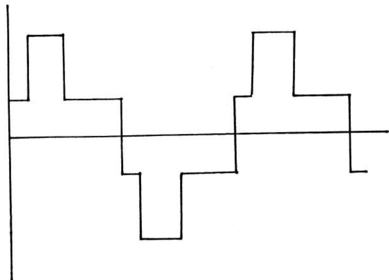
FIG. 5.3. SINTETIZACION TEORICA DE LOS NIVELES DE VOLTAJE DE LOS INVERSORES 1, 2 y 3.
