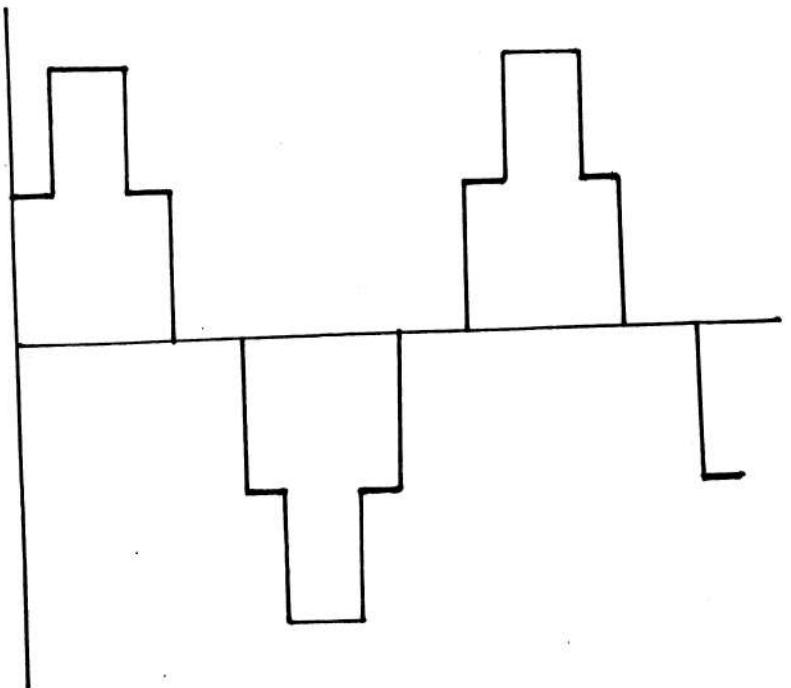
FIG. 5.5. SINTETIZACION TEORICA DE LOS NIVELES DE VOLTAJE DE LOS INVERSORES 1, 2, 3 y 4.
