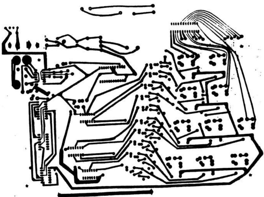
**FIG. 4.1. ARTE DEL CIRCUITO IMPRESO VISTO DEL LADO DE LOS ELEMENTOS.**
