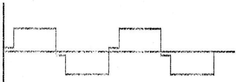
FIG. 5.1. SINTETIZACION TEORICA DE LOS NIVELES DE VOLTAJE EN LOS INVERSORES 1 y 2.
