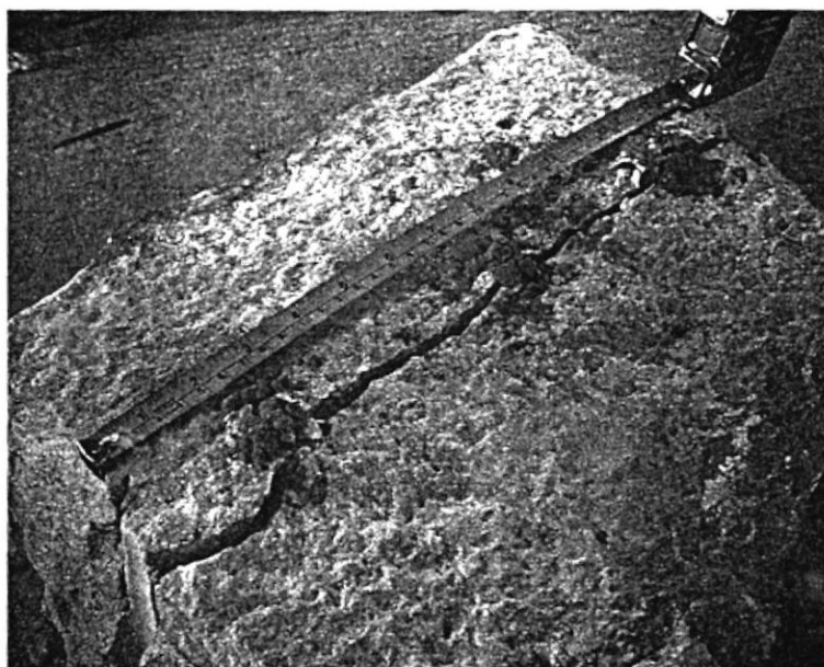
Foto 5.- Fragmentación con espaciamento igual a 10 veces el diámetro de perforación, ensayo número 2.
