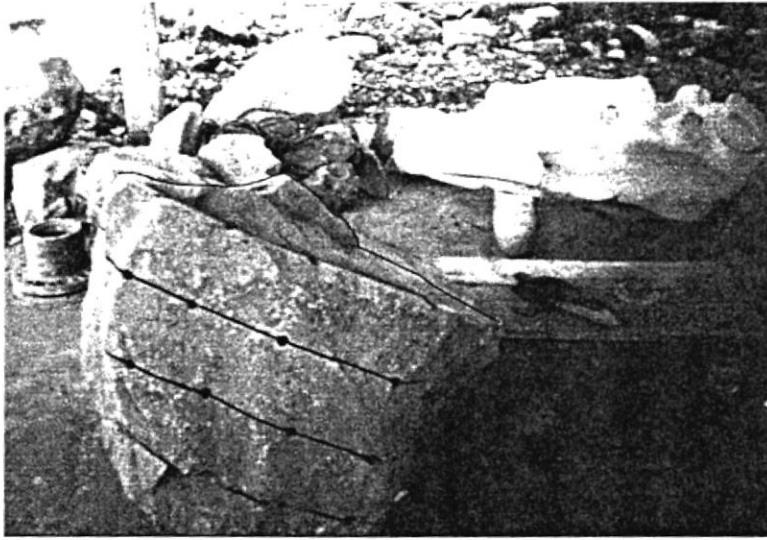
Figura 5.3.- Preparación de bloque de mármol negro, defecto resaltado en rojo (Cortesía Sr. José Cauja).
