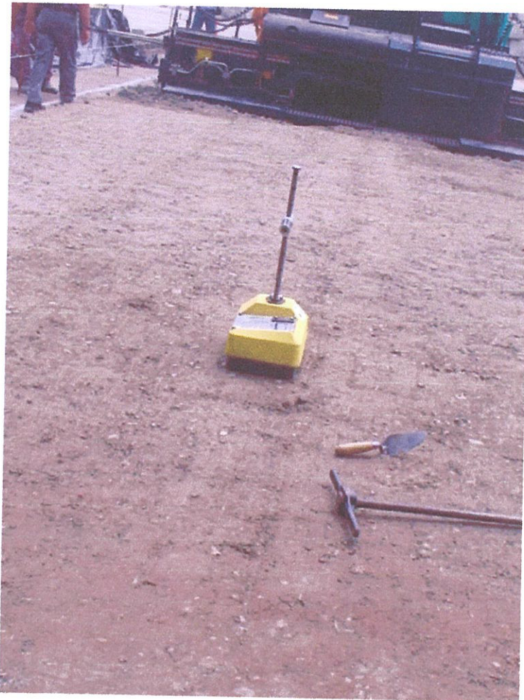
Foto 4 Medición de la densidad de campo por medio de Densímetro nuclear
