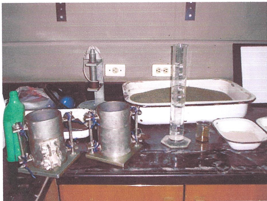
Foto 25 Se prepara los cilindros con el collar.
