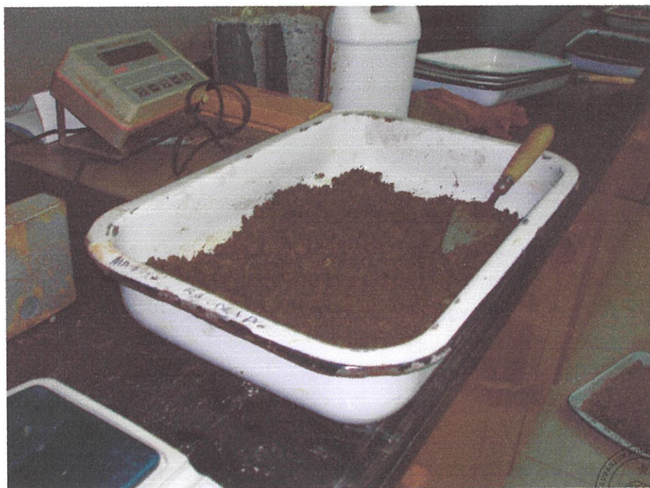
Foto 29 Mezcla de los agregados, cemento, agua y aditivo
