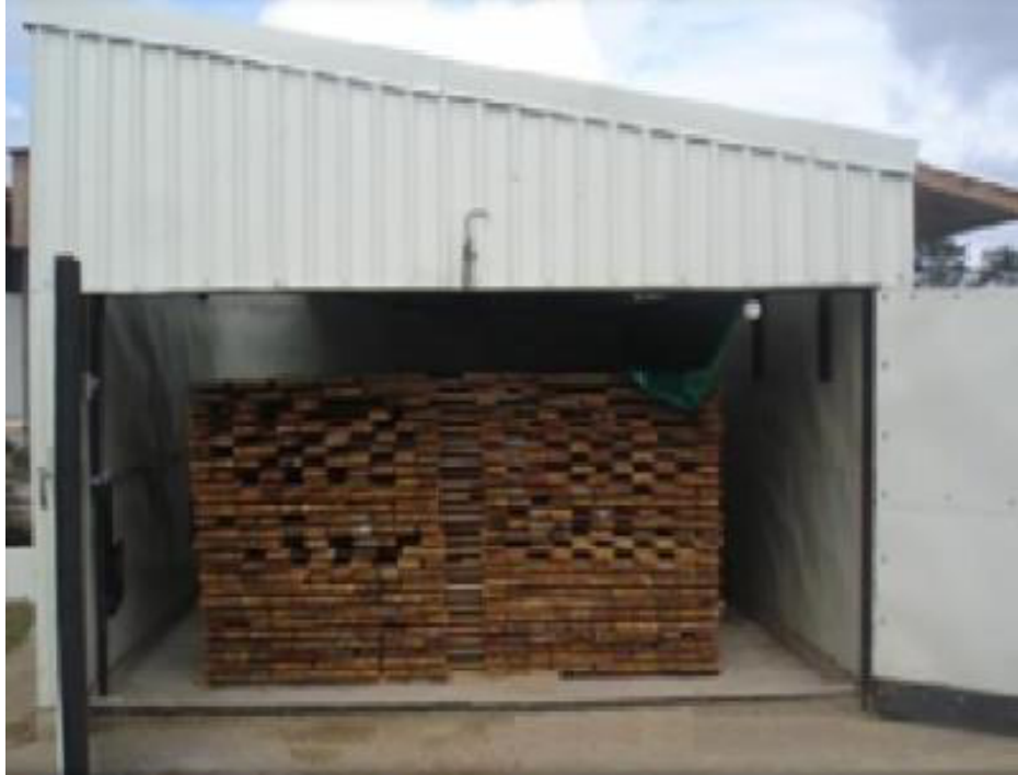
Ilustración 3-5. Listones de madera en horno de secado
