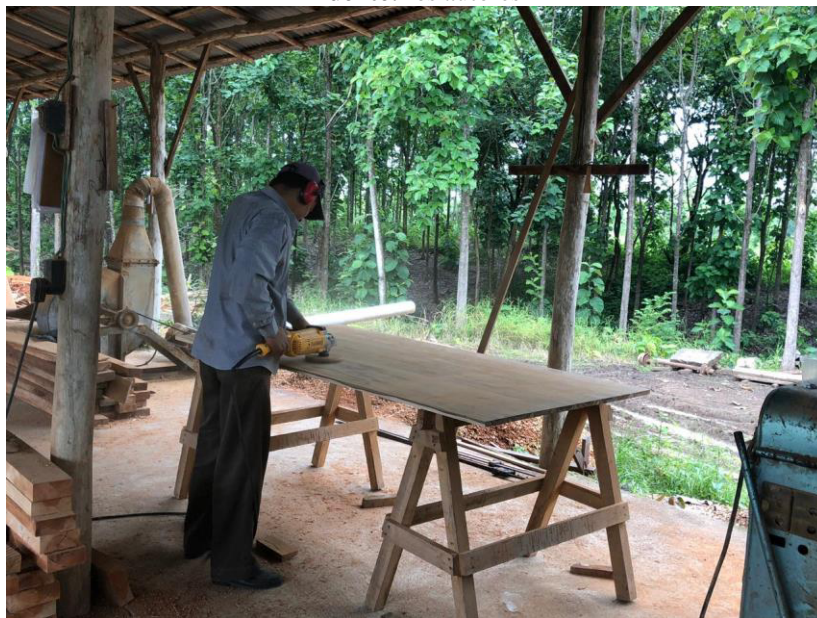
Ilustración 3-10. Pulido de tableros de listones de madera Fuente: los autores
