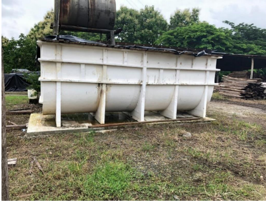
Ilustración 3-4. Curado de listones de madera Fuente: los autores
