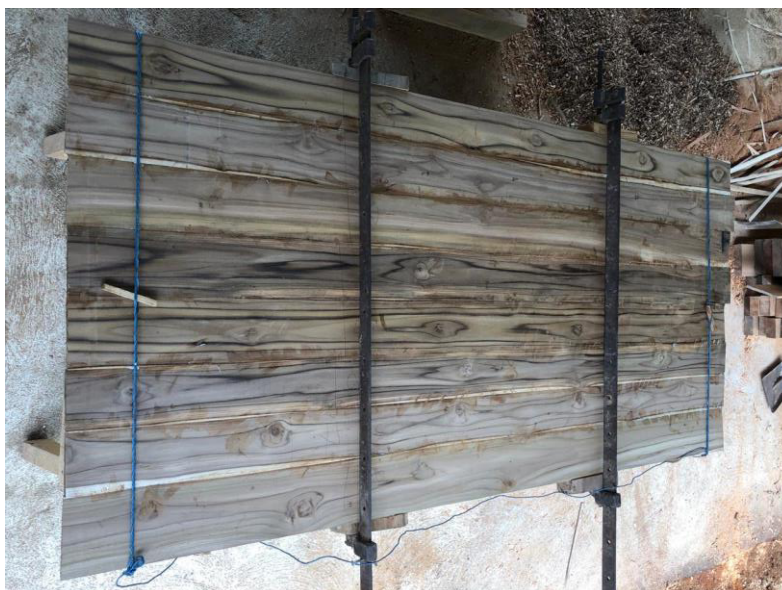
Ilustración 3-8. Prensado de listones de madera
