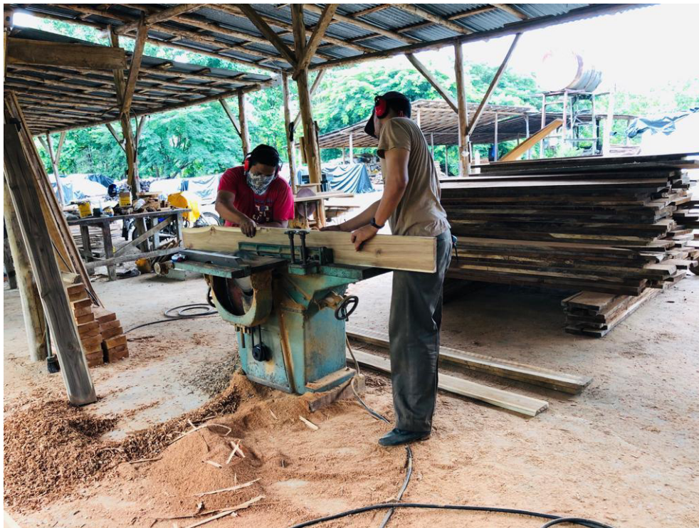
Ilustración 3-6. Canteado y cepillado de tablonces de madera
