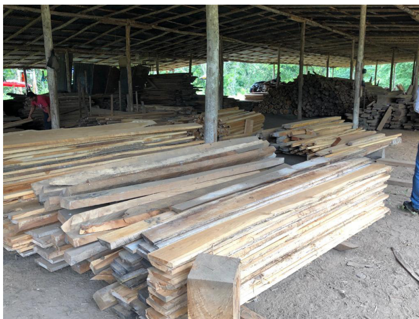
Ilustración 3-3. Bloqueado y generación de listones de madera
