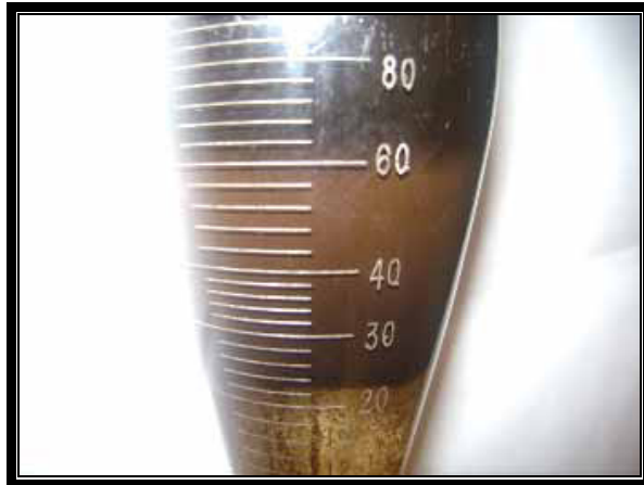
Figura 2.16 Slug (Interfase Agua - Petróleo)
