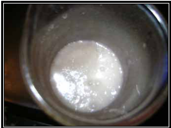
Figura 2.9 Reacción de la Escala con HCl al 15%
