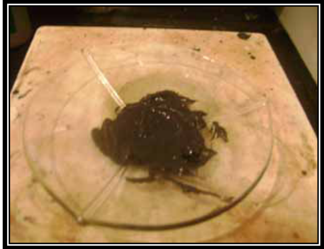
Figura 2.13 Muestra de Parafina más Calor y Agitación sin Solvente
