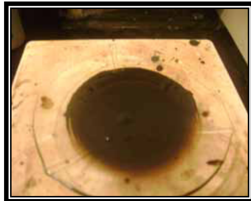
Figura 2.12 Calentamiento de Parafina más Solvente (Xileno)
