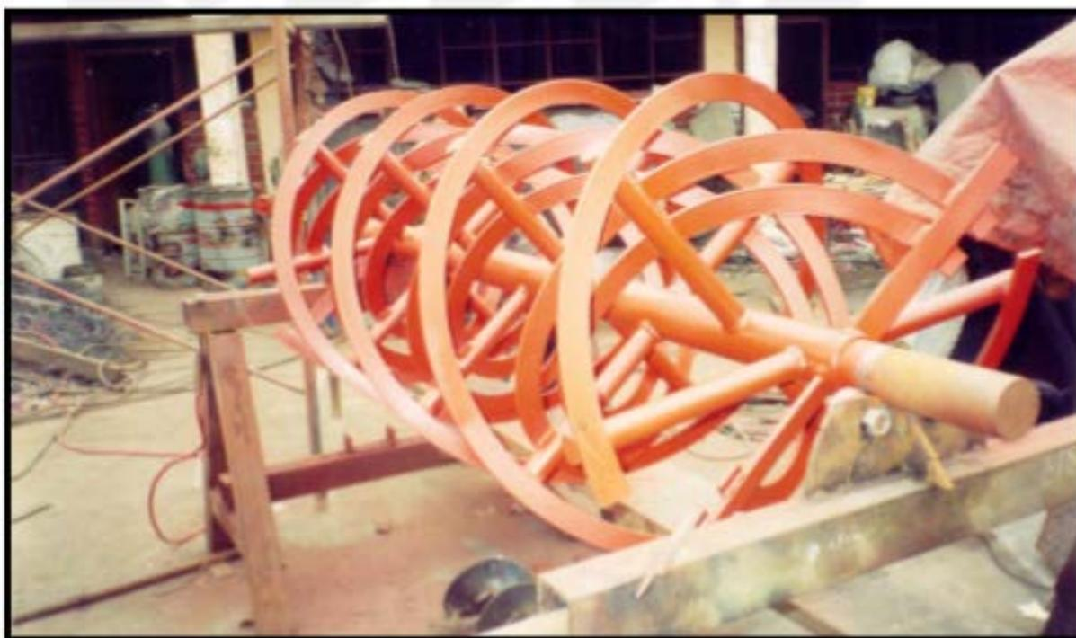
**Ilustración 3-2.** Cintas helicoidales de mezcladora dos interiores y una exterior
