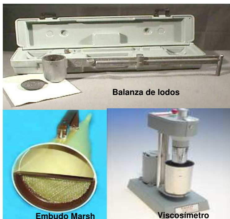
Figura 1.12 Equipos para medir densidad y reología
