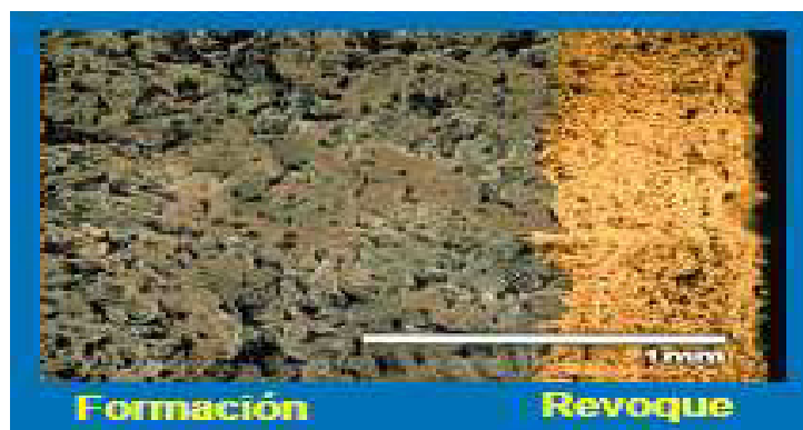
Figura 2.1 El espesor del revoque es fácilmente removido con bajas presiones de producción.
