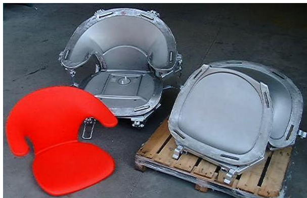
Imagen 7.5 Molde y productos de Rotomoldeo
