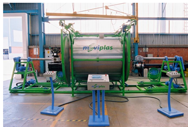
Imagen 7.4 Maquina para Rotomoldeo
