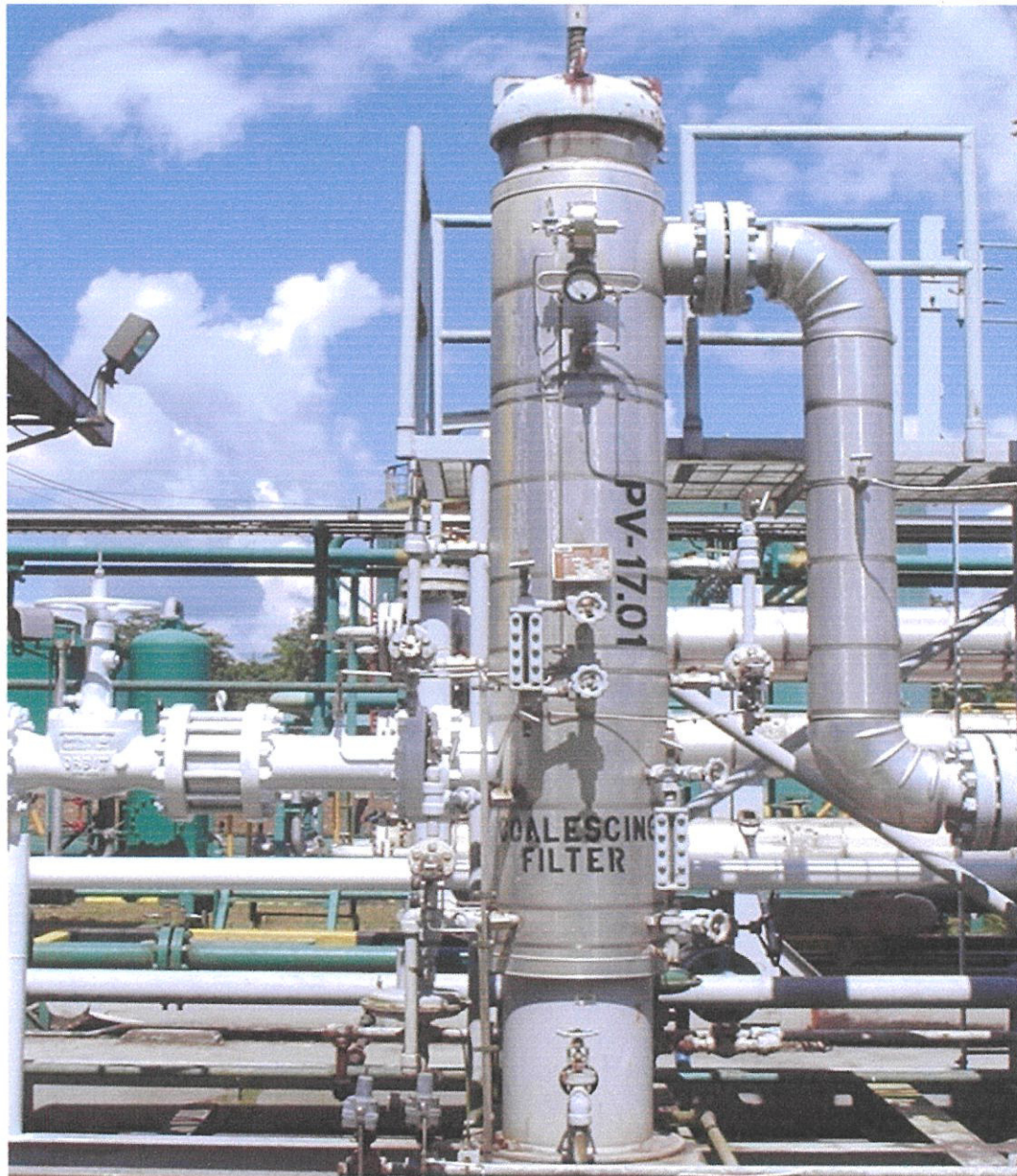
FIGURA 2.6. FILTRO COALESCEDOR (PV-17.01)
