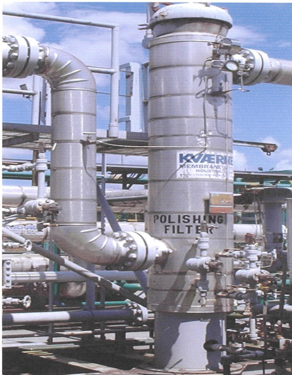
FIGURA 2.7. FILTRO POALESCEDOR (PV-17.02)
