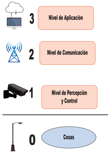
Fig. 9. Estructura para sistema de gestión de alumbrado público basado en IoT
