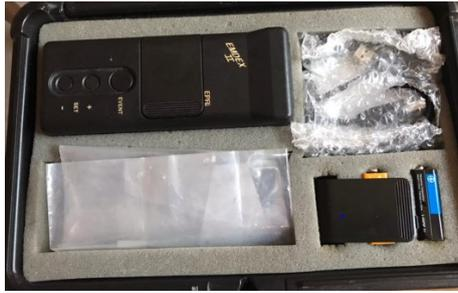
**Fig. 6. Gaussímetro para medición de bajas frecuencias.**
