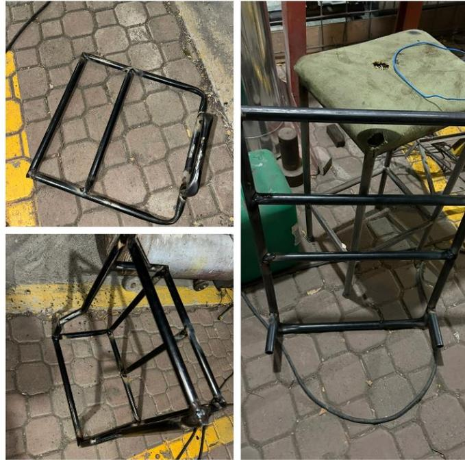
Nota. Chasis, espaldar y reposapiés del dispositivo.
