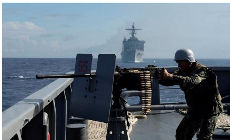
En la Figura 1.5 se observa cómo es el uso de esta estructura junto con la ametralladora. La única protección para el operario está en la parte frontal, en los laterales y en la parte posterior no hay forma alguna de evitar el impacto de balas.
