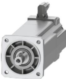
SIMOTICS S-1FK2 CT servomotor M0 = 6 Nm; Pn = 1,45 kW a Nn = 3000 1/min (380-480 V); Pn = 0,86 kW a Nn = 1500 1/min (200-240 V); con freno de mantenimiento; grado de protección IP65; eje D 19 x 40 mm con chaveta; encóder absoluto 22 bits + 12 bits multivuelta (encóder AM22DQC); con interfaz OCC; conector tamaño M17, girable;
