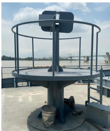
En la Figura 1.3 se observa la estructura completa en la que reposa la ametralladora y el espacio físico que tiene el tripulante para usarla. Sin embargo, la seguridad que tendrá el operario es baja, la única protección que posee es la lámina que se encuentra en la parte frontal.
