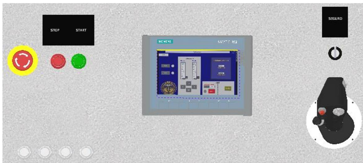
En la Figura se observa el panel de control de la estación de mando, en la izquierda se observa: el botón “*Stop*”, “*Start*” y “*Paro de emergencia*”. En el centro se observa la pantalla HMI, por la derecha se tiene el joystick, y el switch de seguridad con llave.
