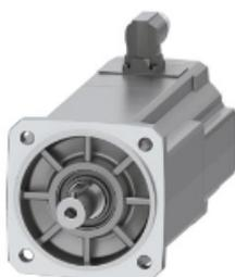
SIMOTICS S-1FK2 CT servomotor  $M_0 = 12$  Nm;  $P_n = 2,85$  kW a  $n_n = 3000$  1/min (380-480 V);  $P_n = 1,72$  kW a  $n_n = 1500$  1/min (200-240 V); con freno de mantenimiento; grado de protección IP65; eje  $D 24 \times 50$  mm con chaveta; encóder absoluto 22 bits + 12 bits multivuelta (encóder AM22DQC); con interfaz OCC; conector tamaño M23, girable;
