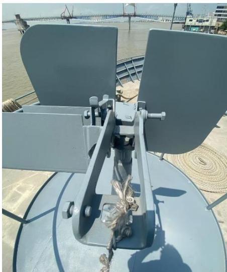
En la Figura 1.4 se puede ver la estructura desde un plano más cercano y apreciamos la lámina frontal de seguridad que habíamos mencionado. Como es evidente esta lámina no otorga un alto nivel de seguridad al tripulante.
