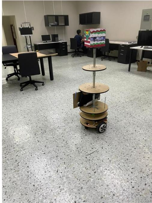
En las pruebas realizadas el robot inicialmente tiene dificultades para encontrar la orientación correcta para la ruta planificada, sin embargo, logra alcanzar la meta final sin ningún otro inconveniente.
