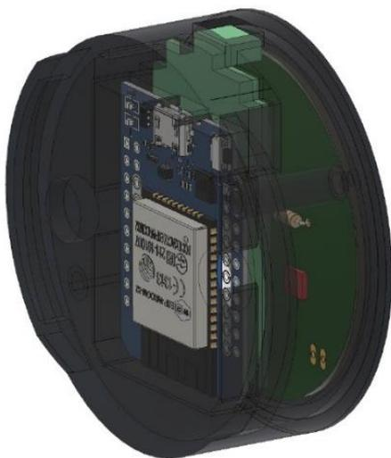
*Nota.* Simulación 3D del interior del case EEM, mostrando la disposición de los componentes electrónicos.
