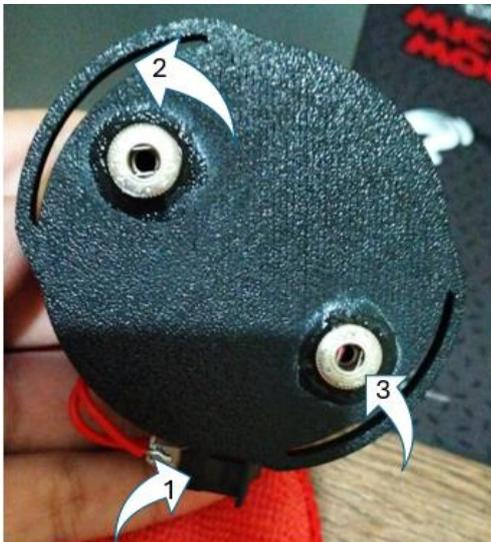
*Nota.* 1: Botón de encendido, 2: soporte para el velcro, 3: toma de electrodos.
