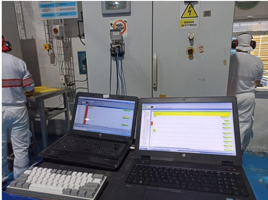
En la **Figura 3.29** se puede apreciar la lógica original del PLC tal como está integrada en el tablero eléctrico, junto con la nueva programación que se va a implementar. Esta comparación permite entender tanto el diseño inicial como las modificaciones realizadas para la actualización del sistema.
