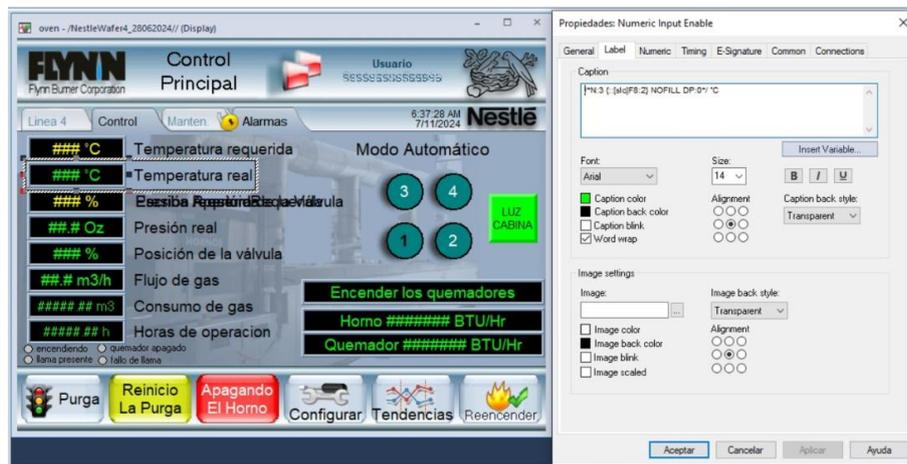
La **Figura 3.8** muestra el apartado HMI, donde se encuentra la variable de interés, en este caso, la temperatura real. Se revisan las propiedades del recuadro, más específicamente el “Label”, ya que, este da a conocer la variable de la programación Ladder que se está usando para mostrar al usuario (F8:2).
