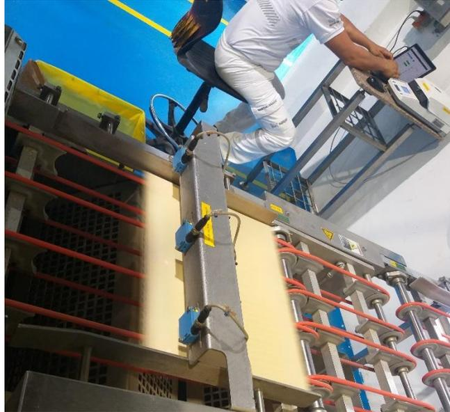
Como se muestra en la **Figura 3.28**, los sensores para el conteo de obleas se instalaron de tal manera que puedan seguir contando incluso si uno de ellos no recibe señal debido a una oblea rota. Por esta razón, en la programación se ha implementado una lógica en paralelo para asegurar la continuidad del conteo.
