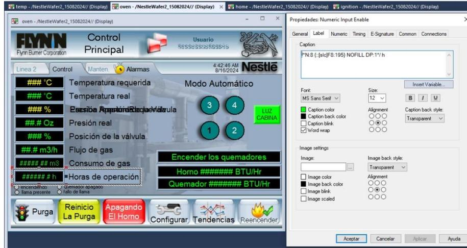
De forma análoga en la **Figura 3.11**, se toma la variable del HMI F8:195, correspondiente a las horas de operación que ve el operador. De esta forma se revisa su conexión en la programación de este.
