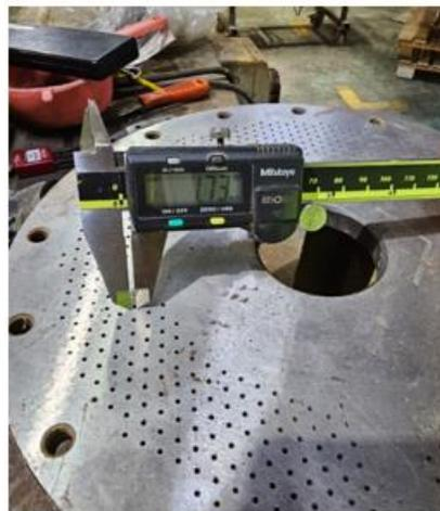
**Problema:** Generación de PNC por diámetro y largo fuera de especificación de tilapia 38% 2 mm. Esto se debe al uso de moldes fuera de especificación. Diámetro mínimo: 1,6 mm; Diámetro
