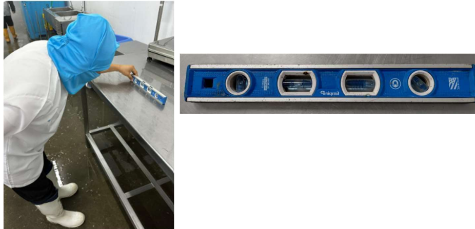
Figura 2.6 Verificación de nivel de mesas
