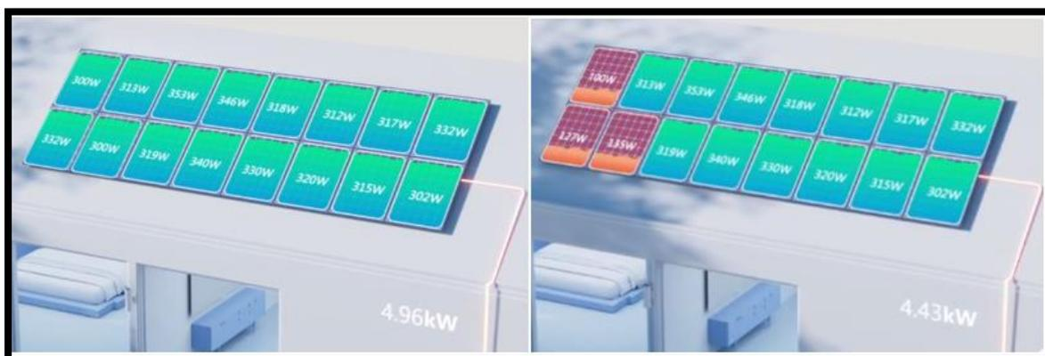
Figura 23. Funcionamiento del micro inverso versus problemas/sombras en los módulos fotovoltaicos (Electronics, 2024)
