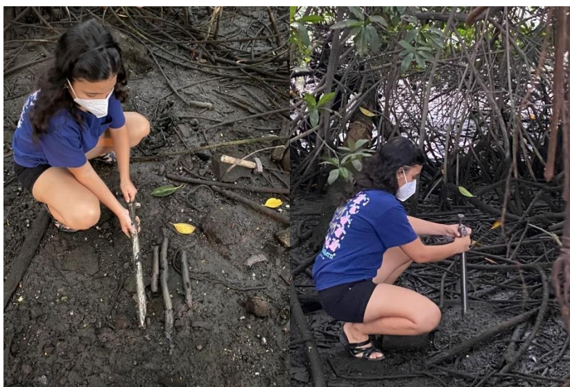
Figura 11. Prueba de prototipos de nucleadores en el suelo del manglar
