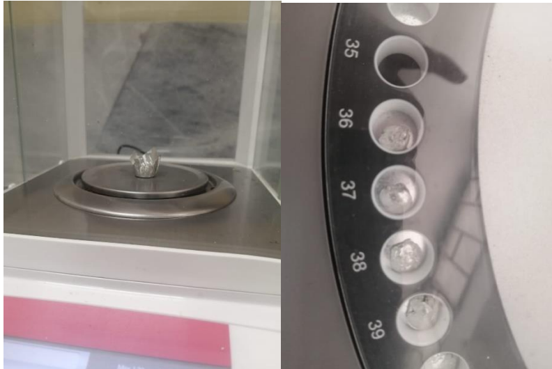
Figura 20. Pesaje de muestras/ muestras en Analyzer Vario Macro
