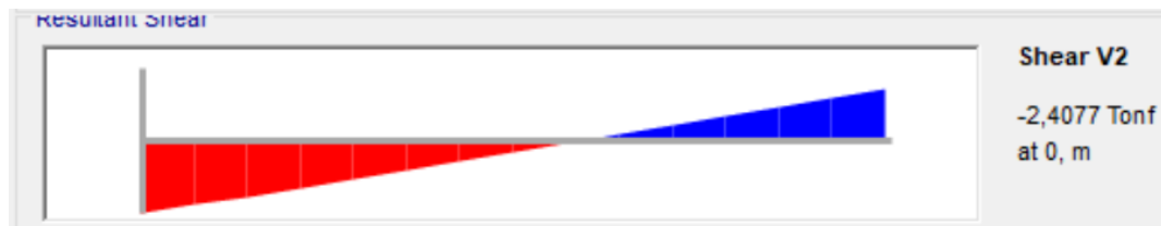
Figura 3.9 Cortante máximo para la losa aligerada
