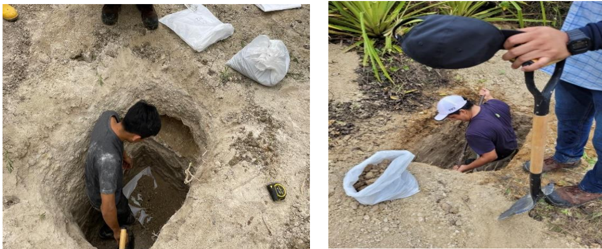
Figura 3 Toma de muestras en calicata 1 y 2
