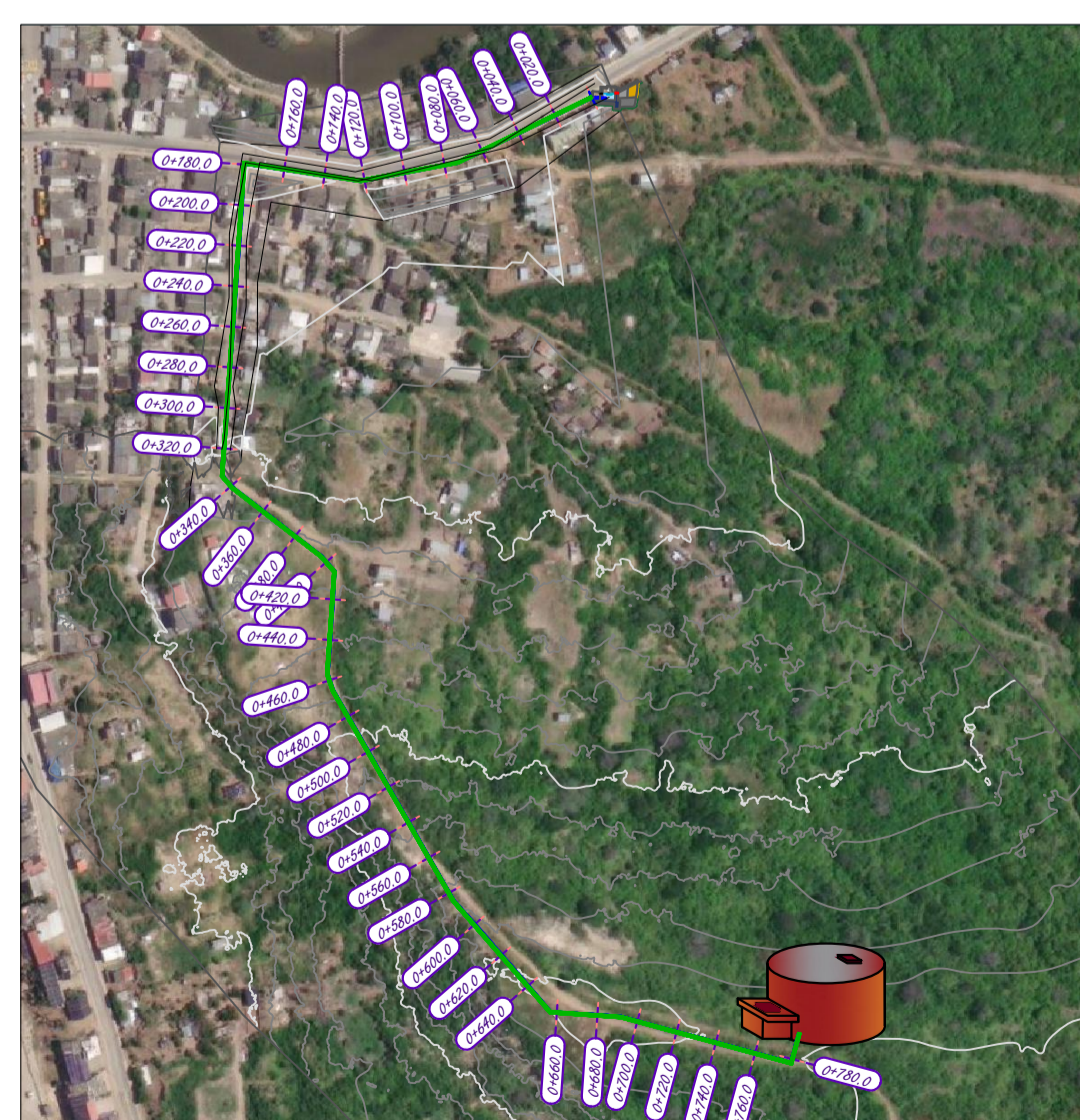
2 IMPLANTACIÓN LÍNEA DE IMPULSIÓN ESCALA: 1:1000
