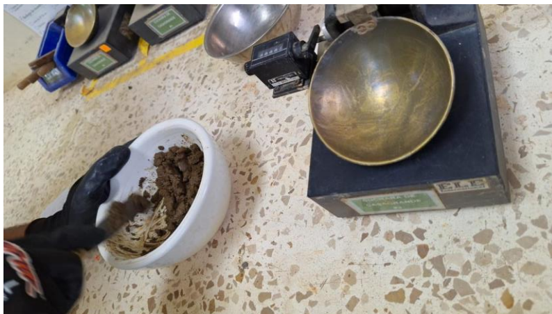
Límites de Atterberg utilizando la cuchara de Casagrande.
